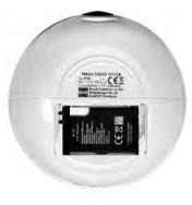
den) oder an ein 5 V Ladegerät, z.B. von Ihrem Smartphone (Panda USB-Buchse @ mit Adapter-USB-Buchse verbinden). Die Ladezeit beträgt ca. 4 Stunden.
