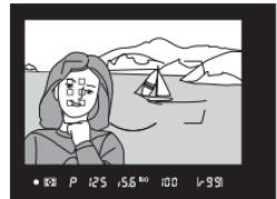
Um eine AF-Messfeldsteuerung auszuwählen, drücken Sie die AF-Modus-Taste und drehen am vorderen Einstellrad, bis die gewünschte Einstellung im Sucher und auf dem oberen Display erscheint.
