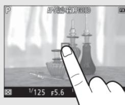
Zum Auswählen der AF-Messfeldsteuerung drücken Sie die AF-Modus-Taste und drehen das vordere Einstellrad, bis der gewünschte Modus auf dem Monitor angezeigt wird.
