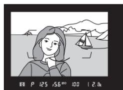
Der Sperrschanter für die Messfeldvorwahl kann nach der Auswahl auf die Position L gedreht werden, damit sich das gewählte Fokusmessfeld nicht unbeabsichtigt ändert, wenn der Multifunktionswähler gedrückt wird.
