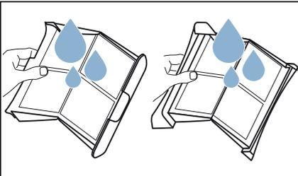
8. Flusensiebe abtrocknen, zuklappen und wieder einsetzen.
