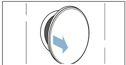
2. Feuchtigkeitssensor mit angerauhtem Schwamm reinigen.
