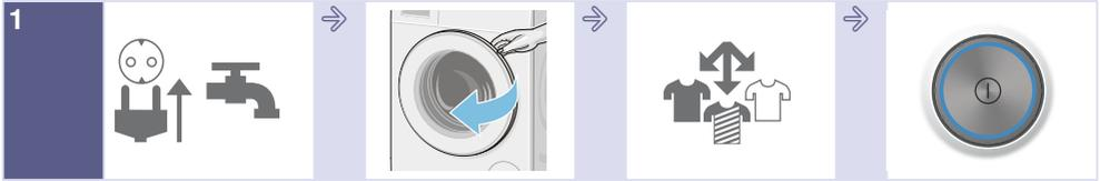
1 Netzstecker einstecken. Einfüllfenster öffnen. Wäsche sortieren. Zum Einschalten Taste ⏻ drücken.
