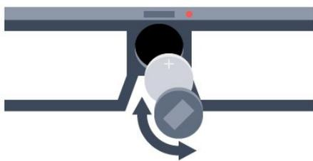
Um die Batterie auszutauschen, drehen Sie die kleine Abdeckung nach links, um das Batteriefach zu öffnen. Tauschen Sie dann die Batterie aus. Verwenden Sie den Typ CR2032 (3 V). Stellen Sie sicher, dass der Pluspol der Batterie sichtbar ist. Setzen Sie die Abdeckung wieder auf, und drehen Sie sie nach rechts, um sie zu schließen.
