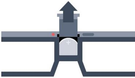
Um die Batterie auszutauschen, drücken Sie den kleinen Knopf auf der Batterieabdeckung, und schieben Sie die Abdeckung auf. Tauschen Sie dann die Batterie aus. Verwenden Sie den Typ CR2032 (3 V). Stellen Sie sicher, dass der Pluspol der Batterie sichtbar ist. Setzen Sie die Abdeckung wieder auf, und schieben Sie sie nach unten, bis Sie ein Klicken hören.
