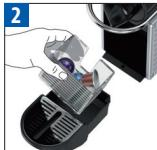
Vácie la bandeja antigoteo y el contenedor de cápsulas usadas.
