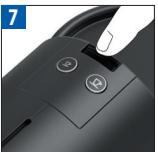
Encienda la máquina. La luz intermitente en ambos botones de café y del contenedor de cápsulas: calentamiento durante unos 25 segundos. Luz continua: preparada.
