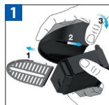
Pro složení držáku šálků a odkapávací nádobky je otocite na stejnou stranu a odklapněte od sebe.
