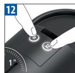
Um den Entkalkungsmodus zu verlassen, drücken Sie beide Tasten für eine Sekunde. Die Maschine ist jetzt betriebsbereit.
