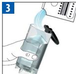
Füllen Sie den Wassertank mit 0,5 l Wasser und fügen Sie die *Nespresso* Entkalkungsflüssigkeit hinzu.
