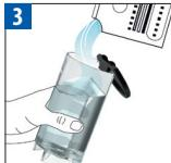
Llene el depósito de agua con medio litro de agua y añada el líquido de descalcificación Nespresso.
