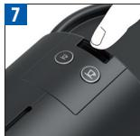
7 Włączyć urządzenie. Pulsujące diody obu przycisków kawy i pojemnika kapsuł: nagrzewanie przez około 25 sekund. Światło stałe: gotowe. Включите кофе-машину. Во время нагревания кофе-машины (примерно 25 секунд) мигают кнопки приготовления кофе и кнопка индикатора наполнения контейнера для капсул. Когда кнопки загорятся ровным светом, кофе-машина готова к эксплуатации.
