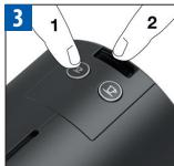
Przycisnąć i przytrzymać przycisk Espresso i włączyć urządzenie. Począć do całkowitego usunięcia wody.
