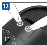
Para salir del modo descalcificación, pulse los dos botones simultáneamente durante un segundo. La máquina está preparada para su uso.
