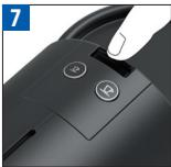
Zapněte přístroj. Tlačítka na kávu a kontejner blikají; probíhá zahřívání kávovaru po dobu přibližně 25 vteřin. Když tlačítka svítí: kávovar je připraven.
