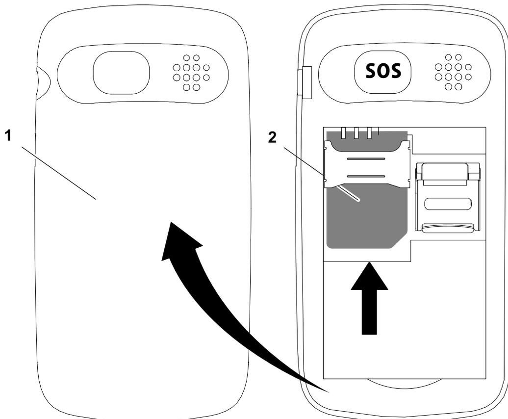
Im Akkufach finden Sie eine hilfreiche Abbildung, die Ihnen zeigt, in welcher Lage und Ausrichtung die SIM-Karte in das Fach eingelegt wird.
