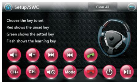
Tippen Sie die Taste der gewünschten Funktion an. Diese Sensor-Taste fängt an rot/grün zu blinken. Anschließend drücken Sie die entsprechende Taste
