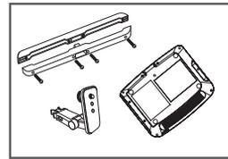
1. Nehmen Sie die Halterung ab, indem Sie die Tasten auf beiden Seiten der Halterung drücken.
