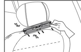
3. Setzen Sie die Halterung an den Trägern der Kopfstütze an und schrauben Sie sie fest.
