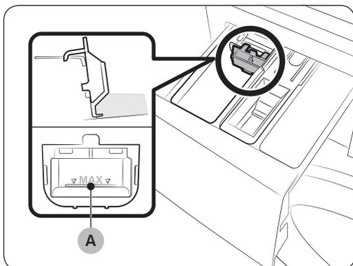
Setzen Sie zunächst den Flüssigwaschmitteleinsatz in das
