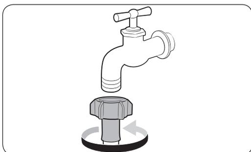
7. Wenn der von Ihnen verwendete Wasserhahn über ein Gewinde verfügt, schließen Sie den Frischwasserschlauch wie in der Abbildung gezeigt mit Hilfe des Gewindeadapters an den Wasserhahn an.
