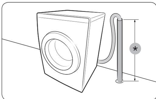
Schlauch in ein Abflussrohr einleiten
