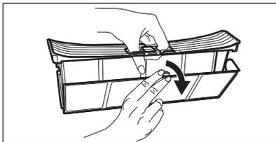
3. Reinigen Sie das Sieb mit der feuchten Hand.
