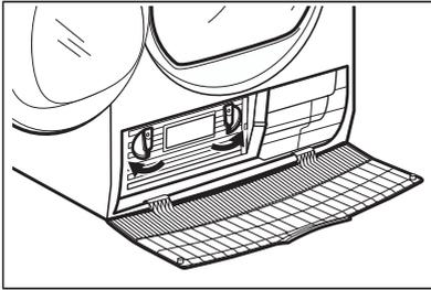
4. Klappen Sie den Kondensatordeckel nach unten.
