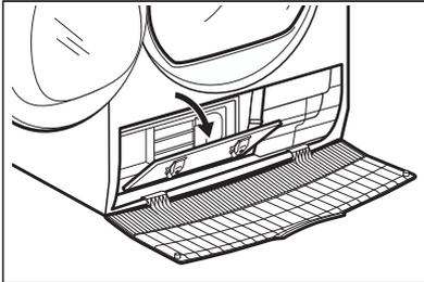
5. Ziehen Sie den Kondensator am Griff aus dem unteren Fach heraus. Halten Sie den Kondensator waagrecht, um das verbliebene Wasser nicht zu verschütten.
