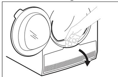
3. Drehen Sie beide Hebel, um den Kondensatordeckel zu entriegeln.
