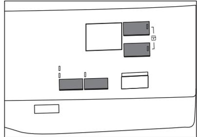
Drücken Sie zum Ein- und Ausschalten einer Option die entsprechende Taste oder eine Tastenkombination. Ist die Option eingeschaltet, leuchtet die Kontrolllampe über der Taste auf oder das Symbol erscheint auf dem Display.
