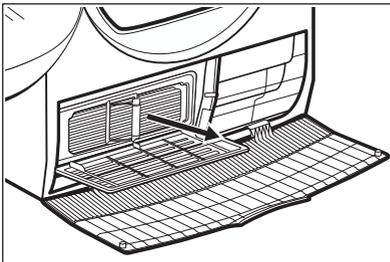
6. Reinigen Sie den Kondensator in senkrechter Lage über einem Becken. Spülen Sie ihn gründlich mit einer Handbrause.
