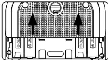
4. Setzen Sie 4 x 1,5V Mignon-Batterien (AA/LR6) ein, wie auf dem Bild im Inneren des Batteriefaches dargestellt. Achten Sie dabei auf die richtige Polung.
