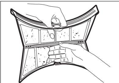
5. Reinigen Sie den Filter bei Bedarf mit einer Bürste und warmem Wasser.
