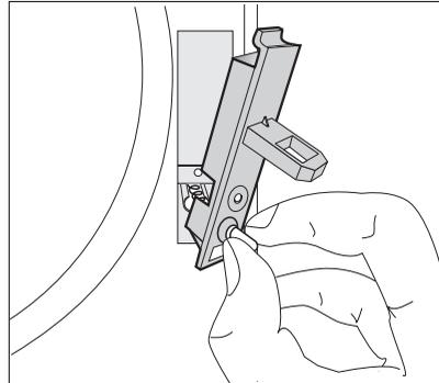
5. Schrauben Sie das Scharnier **A** von der Einfülltür ab, drehen Sie es um 180° und schrauben Sie es auf der gegenüberliegenden Seite wieder an.
