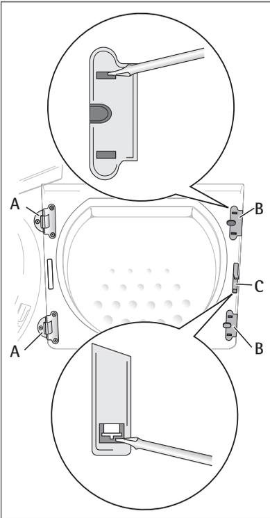
4. Üben Sie mit einem Werkzeug Druck aus, um das Teil **C** zu entriegeln, entfernen Sie es und drehen Sie es um 180°. Setzen Sie es dann in der gegenüberliegenden Seite ein.
