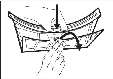
4. Reinigen Sie den Filter mit der feuchten Hand.
