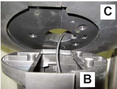
**Standfuss [C]** nun passgenau auf den Gehäuseboden des **Ventilators [B]** aufsetzen und mit den beiliegenden Schrauben befestigen. Das Netzkabel darf dabei nicht eingeklemmt werden.
