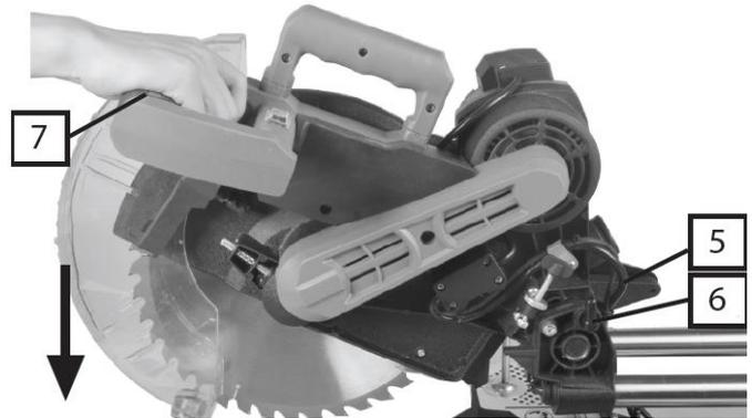
Drehen Sie den Tisch (20), bis der Gehrungswinkelindikator auf 0° gerichtet ist. Ziehen Sie die Gehrungswinkelverriegelung fest.
