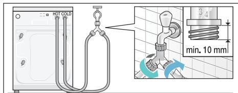
**Hinweis:** Wasserhähne vorsichtig öffnen und dabei Dichtheit der Anschlussstellen prüfen. Schraubverbindung steht unter Wasserleitungsdruck.
