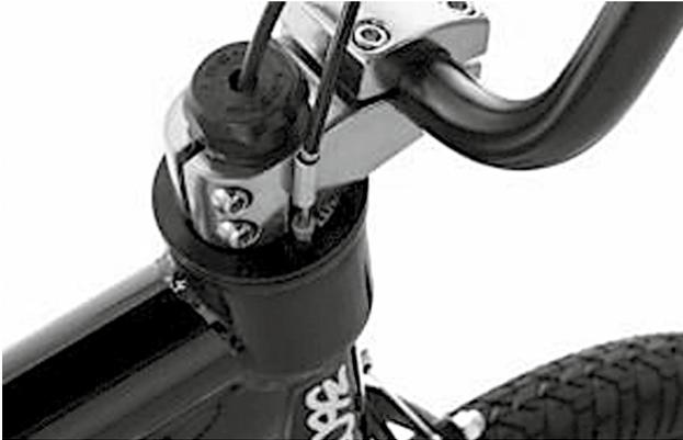
Das F-SET-Rotorsystem ist eine Kombination aus Rotor und Steuersatz. Der Steuersatz ist in Ahead-Bauweise gefertigt, die Einstellung des Steuersatzes erfolgt auch in derselben Weise und ist von der Einstellung der Bremse unabhängig. Schauen Sie zum Einstellen des Steuersatzes daher bitte unter 1. „Vorbau / Lenker / Steuersatz – Ahead-Steuersatz“.
