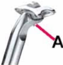
Der Sattel wird in einem zur Sattelstütze gehörenden Kloben befestigt. Fixiert wird der Sattel in der Regel mit einer M8-Inbusschraube **(A)**, welche man mit einem 6er-Inbusschlüssel anzieht. Bringen Sie den Sattel also in die gewünschte Position und ziehen Sie dann die Klemmschraube an.
