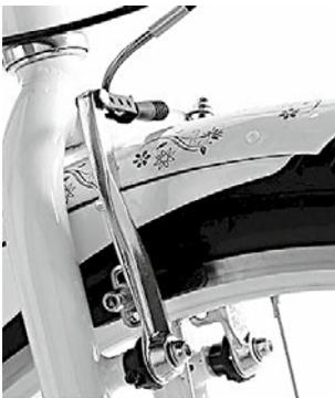
Der Bremszug der V-Brake wird links ein- bzw. ausgegangen. Dazu wird die Bremse zusammengedrückt und die Alupipe in den Bügel der V-Brake eingehangen. Der Bremszug wird auf der rechten Seite durch eine Klemmschraube befestigt, mit dieser Klemmung kann auch grob die Zugspannung eingestellt werden. Man sollte dabei jedoch gewissenhaft arbeiten, wird der Zug zu oft an der Klemmung verstellt, nimmt er Schaden.
