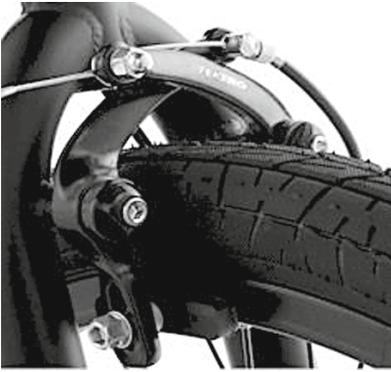
Die Verlegung des vorderen Bremszuges erfolgt von links durch die Hohlsschraube, welche auch zur Einstellung der Zugvorspannung ist. Der Bremszug wird dann auf der rechten Seite in der Lochschraube geklemmt, mit dieser Klemmung kann auch grob die Zugspannung eingestellt werden. Man sollte dabei jedoch gewissenhaft arbeiten, sollte der Zug zu oft an der Klemmung verstellt werden, kann er beschädigt werden.
