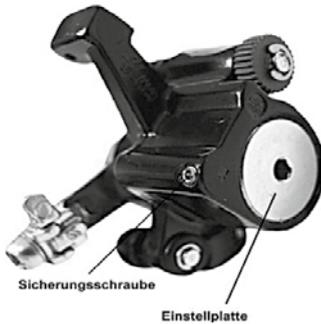
Weiter geht es mit der Einstellung des äußeren Bremsbelages, dieser ist bei der Promax Bremse nur über die Zugspannung des Bremszuges zu verstellen. Dazu die Klemmschraube mit einem 5er-Inbusschlüssel lösen und den Bremszug entsprechend spannen, die Klemmschraube (Drehmoment 6–8 Nm) im Anschluss wieder anziehen. Auch hier sollte der Abstand möglichst gering eingestellt werden. Kleinere Einstellungen können an der Einstellschraube für die Zugspannung am Bremshebel korrigiert werden.
