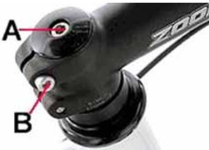
Der Ahead-Vorbau wird auf den Gabelschaft gesteckt und mit ein oder zwei seitlichen Schrauben **(B)** außen auf den Gabelschaft geklemmt. Der Ahead-Vorbau ist nicht in der Höhe verstellbar!
