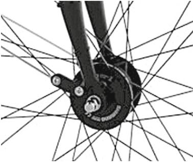
Der Nabendynamo ist genau wie eine entsprechende Vorderradnabe mit Schnellspanner oder normaler Verschraubung zu behandeln. Es ist lediglich auf die Laufrichtung und die Position des Stromanschlusses zu achten. Genaueres dazu finden Sie unter *Nabendynamo* im Kapitel 9 „Beleuchtung“.
