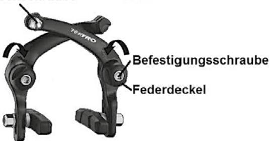
Zum Spannen der Feder dann den Federdeckel der linken Seite im Uhrzeigersinn drehen, den der rechten Seite entgegen dem Uhrzeigersinn. Durch das Spannen der Feder geht der Bremsbelag weiter von der Felge weg. In der Position, wo der Abstand des Bremsbelags zur Felge stimmt, den Federdeckel durch anziehen der Befestigungsschraube (Drehmoment 6–8 Nm) fixieren. Sollte die Federkraft schon sehr hoch sein, kann man die Bremse natürlich auch andersherum durch Entspannen der Feder einstellen.
