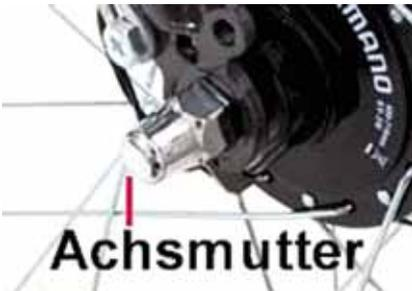
Schrauben Sie die Achsmuttern auf der Achse soweit wie möglich nach außen.
