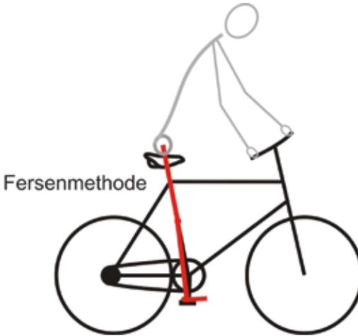
Der Sattel sollte sicher und komfortabel montiert sein. Die richtige Sattelhöhe ergibt sich, wenn Ihr Bein leicht geknickt und der Fuß mit der Ferse auf dem Pedal in der untersten Stellung ist. Das Bein darf nicht durchgestreckt sein.
