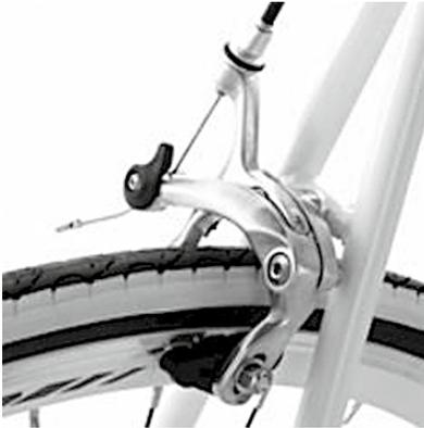
Die Seitenzug- oder Rennbremse wird über einen Bolzen mit Rahmen oder Gabel verbunden. Dieser ist Teil der Bremszange und wird mit einer Hülsenmutter (bei einfacheren Bremsen auch mit einer normalen Mutter) verschraubt. Dafür benötigt man einen 5er-Inbusschlüssel oder bei normalen Muttern einen 10er-Maulschlüssel.
