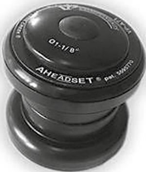
Um den Steuersatz einzustellen, muss der Vorbau gelöst werden. Dazu sind eine oder zwei Schrauben seitlich am Vorbau zu lösen.
