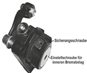
Danach kann der innere Bremsbelag eingestellt werden, dafür ist zuerst die Sicherungsschraube unter der Bremszange mit einem 2er-Inbusschlüssel zu lösen. Ist diese gelöst, kann die Einstellplatte mit einem 5er-Inbusschlüssel eingestellt werden. Der Abstand des inneren Bremsbelages sollte so gering wie möglich zur Bremsscheibe eingestellt werden, die Bremsscheibe sollte aber nicht schleifen. Gesichert wird die Einstellung durch Anziehen der Sicherungsschraube (Drehmoment 4 Nm).
