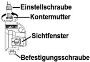
Die Shimano Nexus Schaltnabe wird über eine Schaltbox mit dem Schalthebel verbunden. Dies sollte gemacht werden, nachdem das Hinterrad richtig eingebaut und die Kettenspannung eingestellt wurde. Schauen Sie dazu bitte im Kapitel 8 „Kette / Kettenspannung“ nach.
