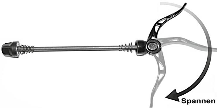
Schnellspanner sollten bei Fahrrädern mit Scheibenbremsen nach Möglichkeit so eingebaut werden, dass sich der Hebel gegenüber der Scheibenbremse befindet. Da die Scheibenbremse sehr heiß werden kann, könnte man sich sonst bei einem Ausbau des Rades verbrennen oder die eventuell vorhandenen Kunststoffteile des Hebels könnten weich werden.
