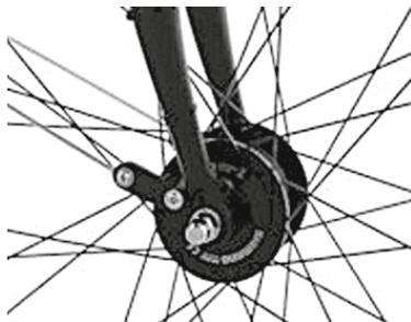
Versuchen Sie nicht, nach dem Festziehen der Achsmutter (Drehmoment 20 Nm) die Anschlussklemme gewaltsam zu drehen. Falls die Anschlussklemme mit Gewalt gedreht wird, kann sie beschädigt werden oder das Kabel in der Anschlussklemme kann unterbrochen werden.
