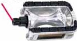
Links und rechts wird dabei immer in Position der Fahrtrichtung bezeichnet. Das rechte Pedal wird im Uhrzeigersinn, also rechts herum eingeschraubt, wie Sie es von gängigen Schrauben gewöhnt sind – Das linke Pedal hingegen gegen den Uhrzeigersinn; also links herum. Deswegen bezeichnet man es auch als Linksgewinde.
