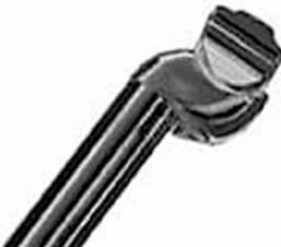
Der Sattel wird hier in einem zur Sattelstütze gehörenden Kloben befestigt, fixiert wird der Sattel in der Regel mit einer M8-Inbusschraube (20 Nm), welche man mit einem 6er-Inbusschlüssel anziehen muss.
