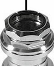
Um den Steuersatz einzustellen, benötigen Sie zwei Gabelschlüssel mit einer Schlüsselweite von je 32 mm (1"-Gabel bzw. -Vorbauschaft) oder 36 mm (1 1/8"-Gabel bzw. -Vorbauschaft). Einen, um die Kontermutter zu lösen, und den anderen für die Lagerschale.
