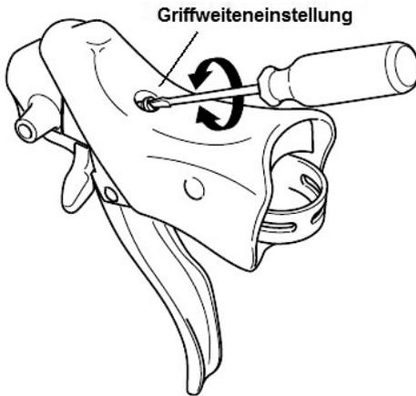
Um den Bremshebel am Lenker zu befestigen, wird er mit einer Schraube an eine Schelle auf dem Lenker geschraubt, diese Schraube finden Sie hinter der Gummiabdeckung der Grifffläche des Bremshebels (siehe Zeichnung oben). Diese Befestigungsschraube ist zu lösen, wenn Sie den Bremshebel in seiner Position verändern möchten. Dies ist bei bereits gewickeltem Lenkerband jedoch nur begrenzt möglich. Im Anschluss die Befestigungsschraube (Drehmoment 6–8 Nm) wieder anziehen.
