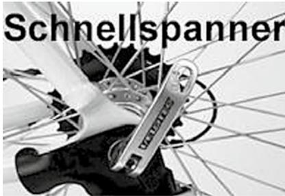
Sofern eine Laufrichtung auf dem Reifen angegeben ist, beachten Sie diese, wenn Sie das Laufrad nun in die Gabel einsetzen. Ist das Vorderrad mit einem Schnellspanner ausgestattet, öffnen Sie diesen bitte und machen wie beschrieben mit der Montage weiter.
