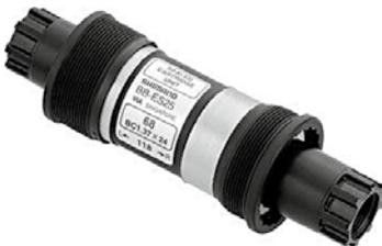
ISIS und Octalink Innenlager sind auch Patronenlager, sie haben jedoch keine Vierkantachse. Die Achse hat bei diesen Lagern einen größeren Durchmesser und für die Kurbelaufnahme einen Vielzahn. Dadurch haben die Lager eine höhere Haltbarkeit, ansonsten ist alles wie beim normalen Patronenlager.
