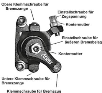
Die mechanische Scheibenbremse von ASSESS sollte zunächst so ausgerichtet werden, dass die Bremsscheibe mittig durch den Spalt in der Bremszange läuft. Dazu müssen die Klemmschraube der Bremszange an Ober- und Unterseite der Bremszange mit einem 4er-Inbusschlüssel gelöst werden. Dann kann die Bremszange seitlich verschoben werden. Ist die richtige Position gefunden, die Klemmschraube (Drehmoment 8 Nm) wieder anziehen.
