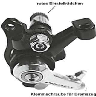
Die mechanische Scheibenbremse von PROMAX sollte zunächst so ausgerichtet werden, dass die Bremsscheibe mittig durch den Spalt in der Bremszange läuft. Dafür gibt es an der Innenseite der Bremszange ein rotes Einstellrädchen, mit dem die Spur der Bremszange von links nach rechts verstellt werden kann.
