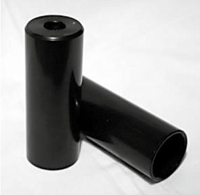
Bitte entfernen Sie vor der Montage der Pegs die Achsmuttern. Die Pegs müssen direkt auf dem Rahmen liegen, da ansonsten die Achse verbogen werden kann. Die Achsmutter sollte anschließend im Peg auf die Achse geschraubt werden, um dieses zu kontern und evtl. das Lösen durch Tricks oder Grinds zu verhindern.
