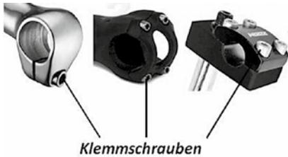
Um den Lenker zu verstellen, lösen Sie die Klemmschraube am Vorbau und drehen den Lenker in die richtige Position. Die Klemmschraube/n (Drehmoment 10–20 Nm) danach wieder festziehen.
