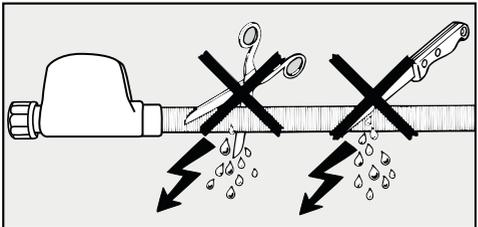
**Die Schutzhülle darf nicht beschädigt oder geknickt werden.**
