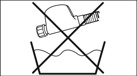
**Das Gehäuse am Wasserzulaufschlauch nicht in Flüssigkeit tauchen!**
