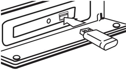
Bei Anschluss eines USB-Gerätes bei eingeleitetem HOME-Menü werden die auf dem USB-Speichergerät enthaltenen Musikdateien automatisch wiedergegeben. Falls auf dem USB-Speichergerät verschiedene Dateitypen gespeichert sind, wird ein Menü zur Auswahl des Dateityps eingeleitet.
