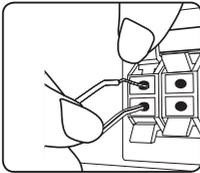
Schließen Sie das schwarze Ende jedes Kabels an die Anschlüsse mit der Bezeichnung - (minus), und das rote Ende jedes Kabels an die Anschlüsse mit der Bezeichnung + (plus) an.
