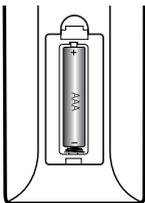
Nehmen Sie die Batterieklappe von der Rückseite der Fernbedienung ab und legen Sie eine Batterie (Größe AAA) mit der richtigen Polung **+** und **-** ein.
