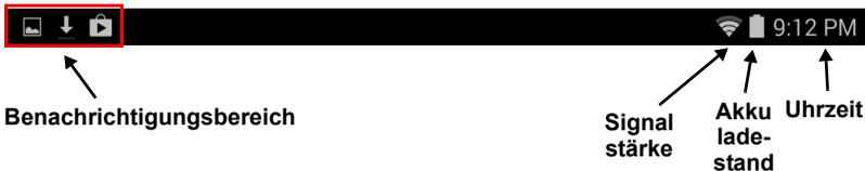
Oben im Fenster werden Status- und Benachrichtigungssymbole angezeigt. Oben rechts werden verschiedene Statusinformationen angezeigt, z. B. Zeit, Akkuladestand und Verbindung. Oben links werden Symbole für Ereignisse angezeigt, z. B. für eine neue Nachricht.
