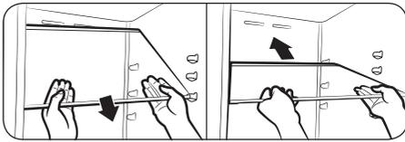
4. Ziehen Sie die Vorderseite nach vorne und haken Sie den Fachboden mit der Rückseite an den rückwärtigen Auflageflächen ein.
