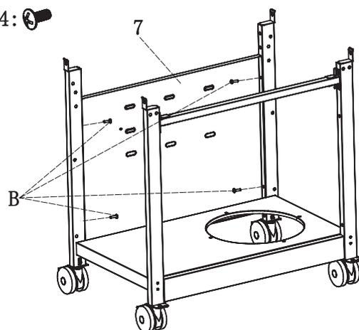
Die Rückwand (7) und die hinteren Standbeine (16B und 9B) mit Schrauben (B) verbinden.
