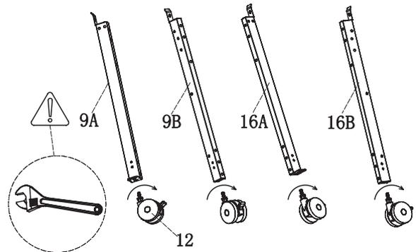
Die Rollen (12) auf die Enden der Standbeine (9A, 9B, 16A und 16B) stecken und festziehen.
