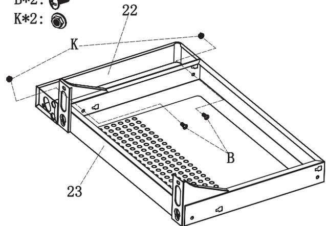
Die Blende für rechte Seitenablage (22) und die rechte Seitenablage (23) mit Schrauben (B) und Muttern (K) verbinden.
