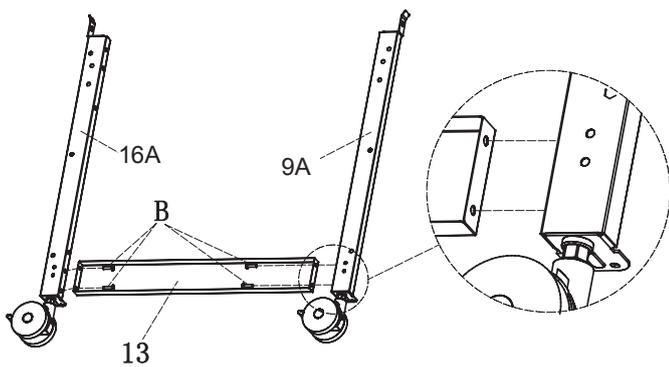
Die vorderen Standbeine (16A und 9A) und Türquerträger unten (13) mit Schrauben (B) verbinden.
