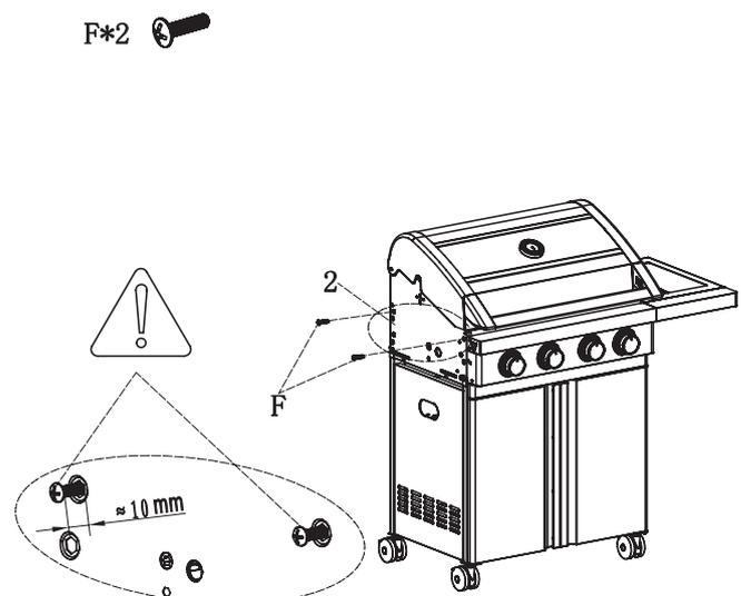
Zwei Schrauben (F), für die linke Seitenablage, bis auf 10 mm in die Seitenwand des Brennergehäuses schrauben.
