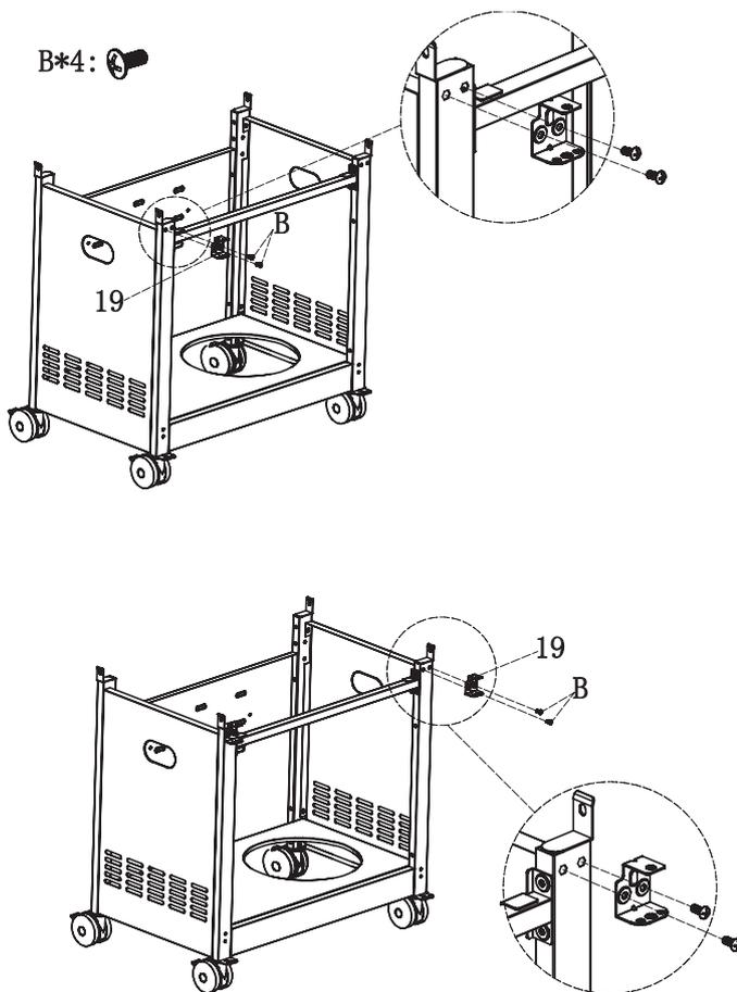
Die Halter für Türquerträgerblende (19) und die Standbeine vorne (9A, 16A) mit Schrauben (B) verbinden.
