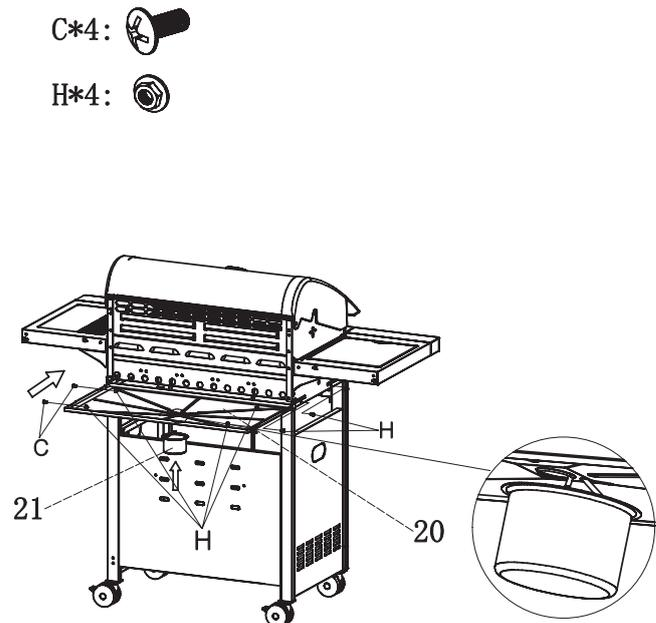
Den Fettauffangbehälter (21) an die Unterseite der Abtropfschale (20) hängen.
