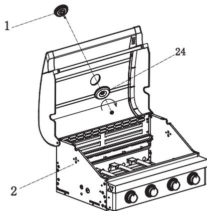
Thermometer (1) durch den Deckel des Brennergehäuses (2) stecken und mit Thermometerfassung (24) verschrauben.
