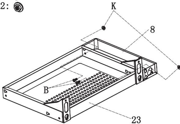
Die Blende für linke Seitenablage (8) und die linke Seitenablage (23) mit Schrauben (B) und Muttern (K) verbinden.
