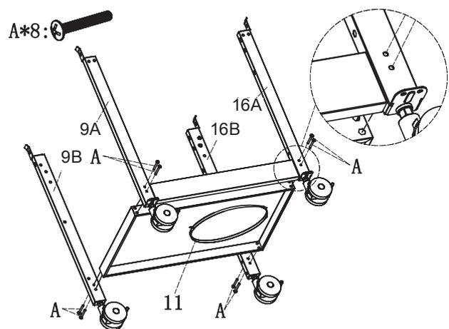
Die Bodenplatte (11) mit Schrauben (A) an die Standbeine vorne (9A, 16A) und hinten (9B, 16B) schrauben.
