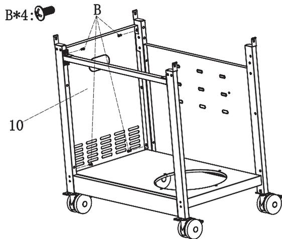
Die linke Seitenabdeckung (10) und die linken Standbeine (9A und 9B) mit Schrauben (B) verbinden.
