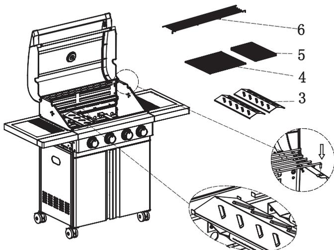
Die Flammverteilerplatten (3), den Grillrost (4), die Grillplatte (5) und das Warmhaltegitter (6) auf dem Brennergehäuse (2) platzieren.
