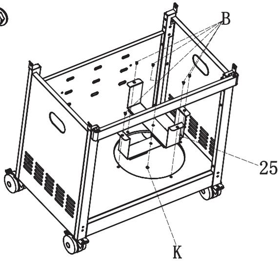
Die Gasflaschenträger (25) mit Schraube (B) und Mutter (K) verbinden und mit Schrauben (B) an die Bodenplatte schrauben.
