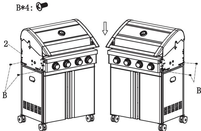
Das Brennergehäuse (2) mit Schrauben (B) an den Standbeinen vorne links (9A), hinten links (9B) und den Standbeinen vorne rechts (16A) und hinten rechts (16B) befestigen.
