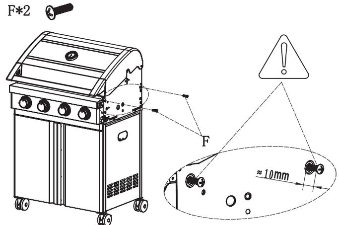
Zwei Schrauben (F), für die rechte Seitenablage, bis auf 10 mm in die Seitenwand des Brennergehäuses schrauben.
