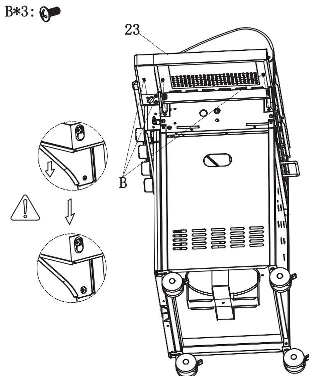
Die rechte Seitenablage (23) einhängen und mit Schrauben (B) befestigen.
