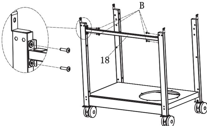
Die vorderen Standbeine (16A und 9A) und Türquerträger oben (18) mit Schrauben (B) verbinden.
