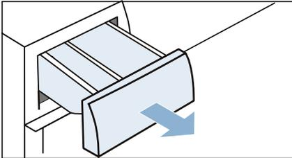
2. Einsatz herunterdrücken und Waschmittelschublade herausziehen.
