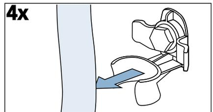
2. Alle 4 Schrauben der Transportsicherungen mit einem Schraubenschlüssel SW13 lösen und entfernen.
