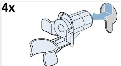
5. Abdeckkappen einsetzen und durch Druck auf den Rasthaken fest verriegeln.
