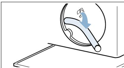
8. Verschlusskappe abziehen und Lauge in geeignetes Gefäß abfließen lassen.
