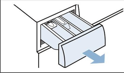
2. Einsatz herunterdrücken und Waschmittelschublade vollständig herausnehmen.
