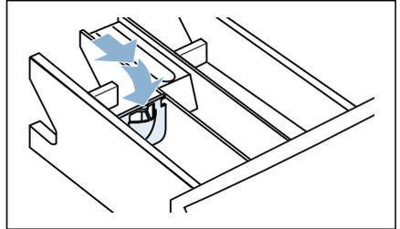
5. Waschmittelschublade einsetzen und schließen.
