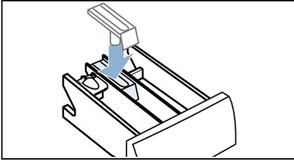
6. Gehäuse der Waschmittelschublade im Gerät reinigen.
