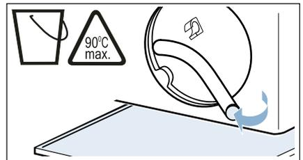
10. Entleerungsschlauch in die Halterung einsetzen.
