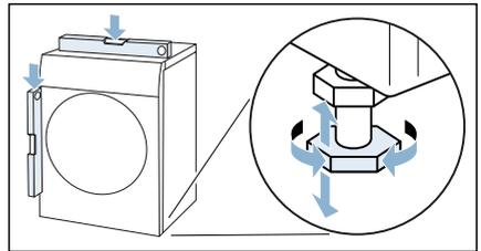
3. Kontermuttern mit einem Schraubenschlüssel SW17 handfest gegen das Gehäuse festziehen. Den Fuß dabei festhalten und in der Höhe nicht verstellen.
