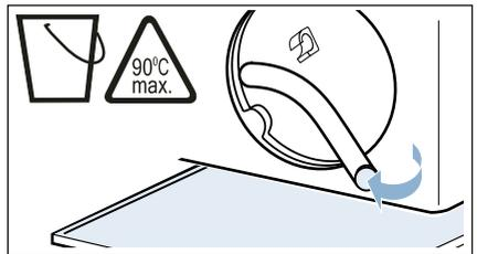
10. Entleerungsschlauch in die Halterung einsetzen.
