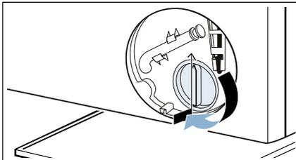
14. Serviceklappe einsetzen und einrasten.
