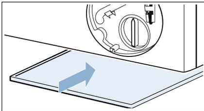
7. Entleerungsschlauch aus der Halterung nehmen.
