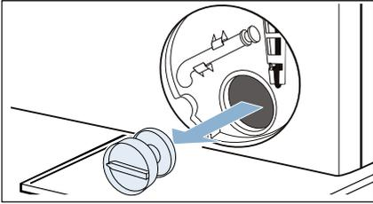
12. Innenraum, Gewinde des Pumpendeckels und Pumpengehäuse reinigen.
