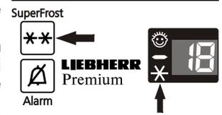
**Achtung:** Bei Betätigen der SuperFrost-Taste kann es durch die eingebaute Einschaltverzögerung zu einem bis zu 8 Minuten verspäteten Einschalten des Kompressors kommen. Diese Verzögerung erhöht die Lebensdauer der Kältemaschine.
