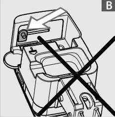
**16** Wenn sich der Auslauf nicht im oberen Bereich der Karaffe montieren lässt, bedeutet dies, dass sich der Bolzen in einer falschen Position (B) befindet. Vor der Anbringung des Auslaufs den Bolzen in Position (A) bringen, indem er manuell verschoben wird.
