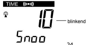
Die Schlummerzeit (Snooze) kann auf AUS (OFF) geschaltet oder auf eine Maximalzeit von 30 Minuten eingestellt werden (Voreinstellung 10 Minuten):
