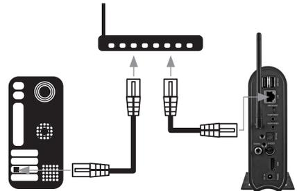
**! [Anmerkung]** Sie können den IB-MP308 mit einem "Crosskabel" direkt mit ihrem PC verbinden ohne einen HUB oder Switch zu benutzen.
