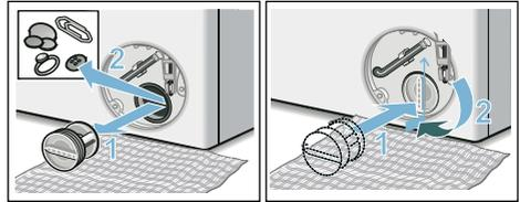
6. Service-Klappe einsetzen, einrasten und schließen.
