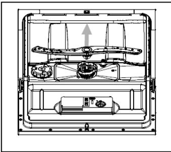
Die Sprüharme müssen regelmäßig von Kalkablagerungen befreit werden, sonst könnten die Düsen und Lager der Sprüharme verstopfen. Zum Entfernen des Sprüharms, die Mutter nach rechts drehen, um die Unterlegscheibe auf dem Arm herauszunehmen und dann den Sprüharm selbst entfernen. Die Arme in warmem Seifenwasser reinigen und mit einer weichen Bürste die Düsen säubern. Danach alles gut unter laufendem Wasser abspülen.
