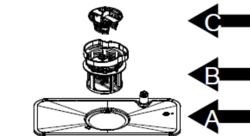
Schritt 1 und 2: Drehen Sie den Siebzylinder gegen den Uhrzeigersinn und heben den Sieb ab (A,B,C).
