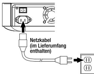
Stellen Sie den Netzschalter auf der Rückseite des Receivers auf „On“. Die Ein/Standby-Anzeige des Receivers leuchtet nun *orange*, um anzuzeigen, dass sich der Receiver im Standby-Modus befindet.
