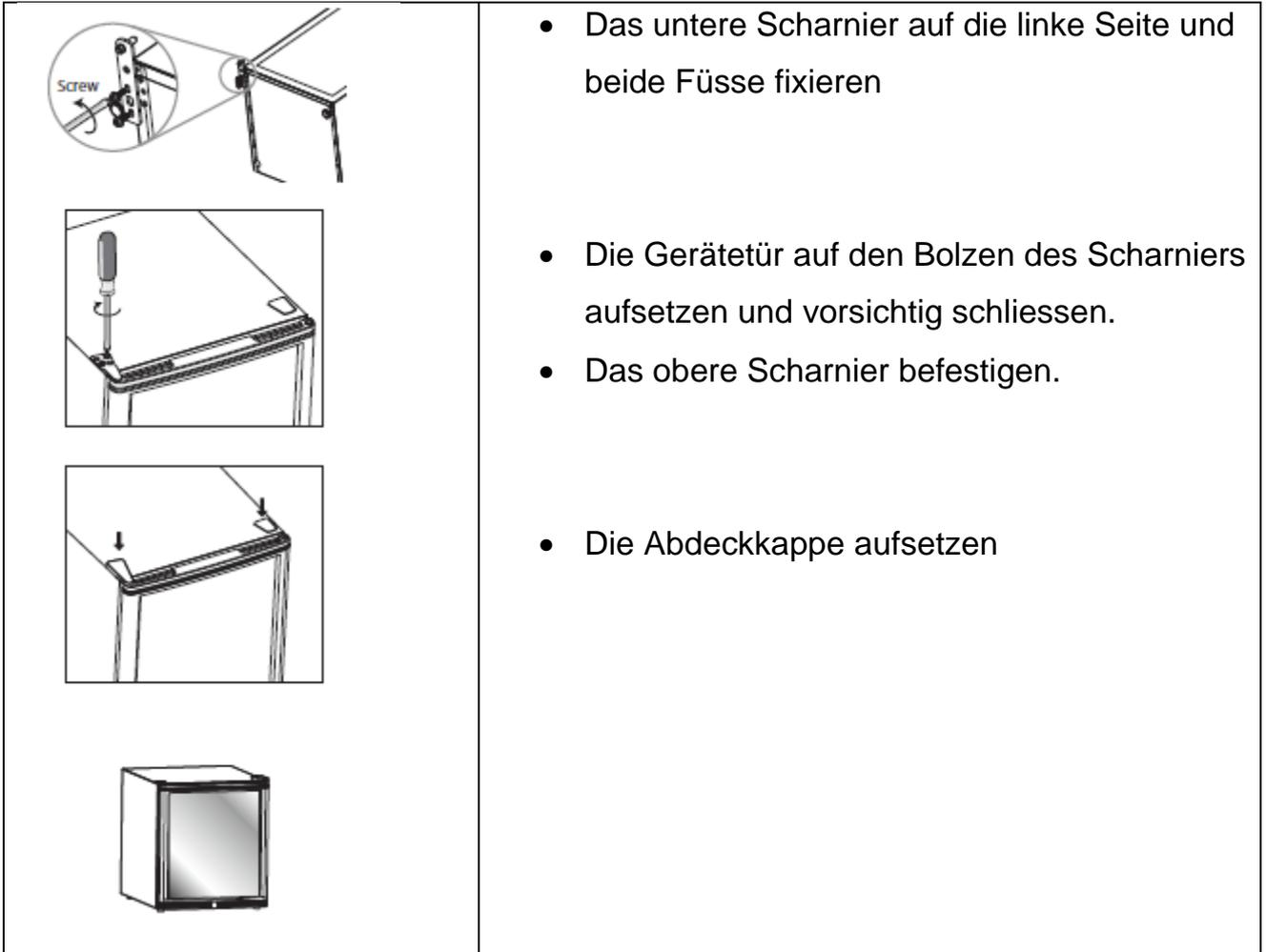
**Bevor das Gerät eingeschaltet wird prüfen sie noch einmal den passgenauen Sitz der Türen.**
