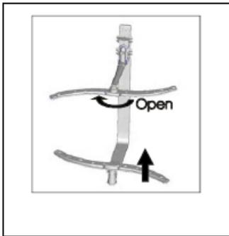
Die Sprüharme müssen regelmäßig von Kalkablagerungen befreit werden, sonst könnten die Düsen und Lager der Sprüharme verstopfen. Zum Entfernen des Sprüharms, die Mutter nach rechts drehen, um die Unterlegscheibe auf dem Arm herauszunehmen und dann den Sprüharm selbst entfernen. Die Arme in warmem Seifenwasser reinigen und mit einer weichen Bürste die Düsen säubern. Danach alles gut unter laufendem Wasser abspülen.
