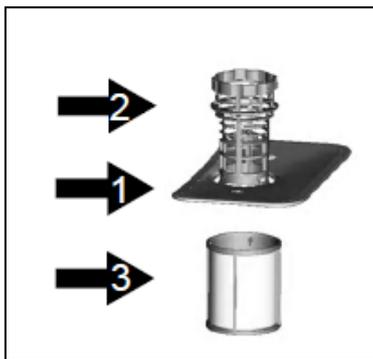
**1. Hauptsieb:** Speise- und Schmutzteilchen werden in diesem Sieb gesammelt und von einem Spezialstrahl auf dem unteren Sprüharm nach unten durch den Wasserablauf gedrängt.
