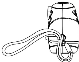
3. Vergewissern Sie sich, dass die Schlaufe sicher an dem Metallstift befestigt ist.
