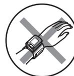
Entfernen Sie den Klettverschluss nicht, indem Sie ihn abdrehen. Stellen Sie sicher, dass Sie das Ablösen in horizontaler Richtung an der Manschette entlang durchführen.
