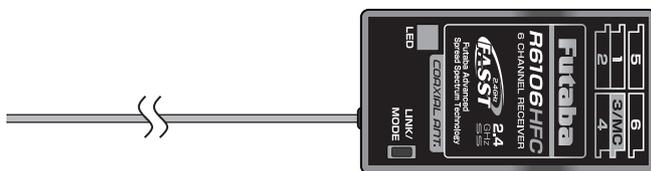
Kleiner, leichter 6-Kanal FASST Empfänger mit stirnseitigen Anschlüssen. Umschaltbar für Digital und Analogservos, wodurch die Impulsausgabe für Digitalservos schneller erfolgt, was zu einer noch kürzeren Reaktionszeit führt. Einsetzbar im gesamten Modellbaubereich, die 14 cm lange Antenne kann bei diesem Empfänger aus Rumpfen oder Chassis aus CFK oder Metall nach außen verlegt werden. Nicht für Großflugmodelle und Jets empfohlen.
