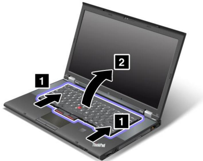
8. Heben Sie die Tastatur vorsichtig an, bis Sie sehen, wie sie angeschlossen ist. Halten Sie die Tastatur über dem Computer, und ziehen Sie den Stecker ab. Entfernen Sie die Tastatur.
