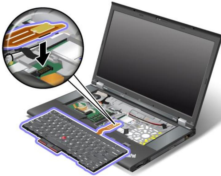
2. Setzen Sie die neue Tastatur ein. Stellen Sie sicher, dass sich die hinteren Kanten der Tastatur unter dem Rahmen befinden.
