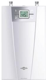
Elektronisch geregelter Durchlauferhitzer als Untertischgerät im Kompaktformat für die energieeffiziente Warmwasserversorgung einer Küchenspüle. Die Elektronik regelt die Leistungsaufnahme bis zur Leistungsgrenze, um die eingestellte Auslauftemperatur gradgenau zu erreichen und konstant zu halten. Die Wunschtemperatur wird direkt am Tastenbedienfeld zwischen 20 °C und 60 °C eingestellt. Mit den beiden Programmtasten können zwei individuelle Temperaturen gespeichert und abgerufen werden.
