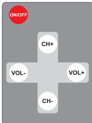
**ON/OFF** nimmt das Gerät aus dem Betriebszustand in Stand-By und aus Stand-By in den Betriebszustand zurück.
