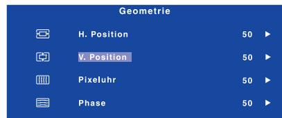
Verwenden Sie dann die Tasten ◀/▶, um die Einstellungen für die vertikale Position zu ändern. Hierbei sollte die vertikale Position der allgemeinen Anzeige ebenfalls entsprechend angepasst werden.
