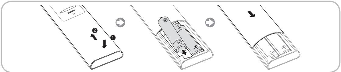
1. Drücken Sie mit beiden Daumen ganz unten auf der Rückseite auf die Fernbedienung, und schieben Sie die Batteriefachabdeckung in Pfeilrichtung.
