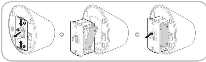
1. Halten Sie die Batteriehalterung an beiden Seiten fest, und ziehen Sie sie heraus.
