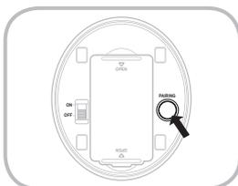
1. Schalten Sie den IR-Blaster ein. Sobald die LED-Anzeige blinkt, müssen Sie den IR-Blaster mit dem Fernsehgerät verbinden.
