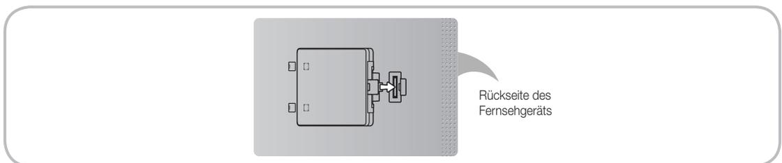
Dieser Steckplatz dient zum Anschließen eines Erweiterungsgeräts mit dem Namen Evolution Kit. Mit dem Evolution Kit können Sie eine Vielzahl neuer Anwendungen ausführen.
