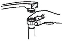
Schließen Sie den Kaltwasser-Zulaufschlauch an ein Anschlussstück mit 3/4“-Gewinde an; achten Sie dabei auf festen Sitz. Wenn die Wasserrohre neu sind oder längere Zeit nicht verwendet wurden, lassen Sie Wasser ablaufen, bis das nachströmende Wasser klar ist. Diese Vorsichtsmaßnahme ist erforderlich, um ein Verstopfen des Wasserzulaufs und Schäden am Gerät zu vermeiden.
