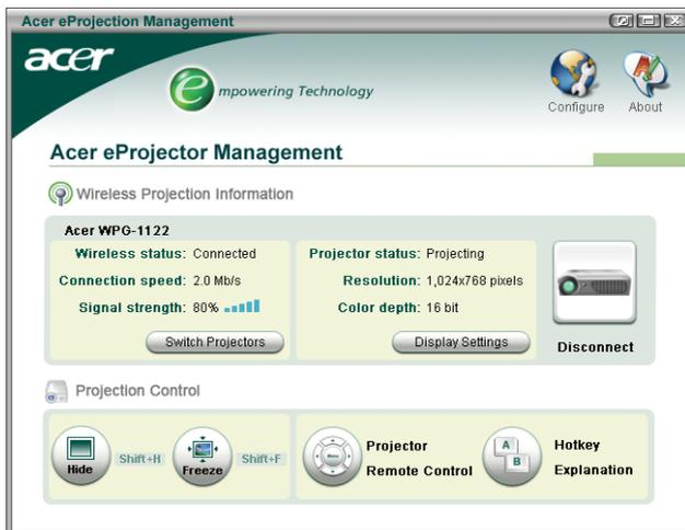
Die Anwendung erkennt verfügbare WPGs automatisch. Jeder WPG wird durch „AcerWirelessGateway-“ in der SSID gekennzeichnet. Falls der Projektor fest an einem Ort aufgestellt sein sollte, können Sie diesem Projektor auch eine ganz bestimmte SSID zuweisen, die zum Beispiel die Nummer des Raumes anzeigt, in dem der Projektor installiert ist (siehe auch „Konfiguration“ weiter hinten in dieser Anleitung).
