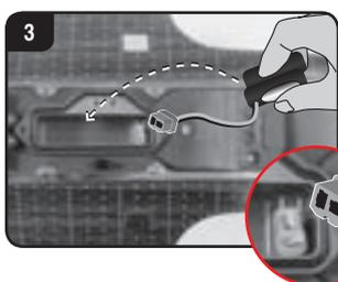
Koppla ihop kabeländan för Carrera RC-båten med den för ackumulatorn. Lägg i ackumulatorn. Skruva tillbaka locket.
