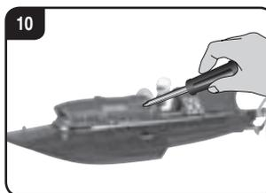
Carrera RC -veneen asennus on tarkastettava ennen jokaista ajoa ja sen jälkeen, tarvittaessa ruuvit ja mutterit kiristetään.
