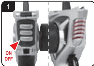
Wenn der Controller eingeschaltet ist leuchten die roten LED-Lampen im vorderen Bereich des Controllers.
