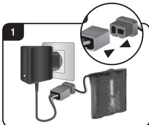
Vennligst forbind først Carrera RC-akkumulator med vedlagt ladeapparat. Forbindelsesstykket eller forbindelsen mellom akkumulator og ladeapparat er produsert slik at feil polaritet utelukkes. Forbind ladeapparatet med en energikilde.
