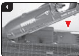
Placez à nouveau soigneusement la partie supérieure du bateau (avec corps et cockpit) sur le fuselage. Assurez-vous que l'interrupteur à glissière s'enclenche correctement.
