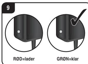
9 For at undgå, at der optræder fejl på Carrera RC-bådens styresystem og at den derfor sejler ukontrolleret skal det kontrolleres, at batterierne i controlleren og bådens akku'er er korrekt opladet. Kortsut ikke opladere og strømforsyningen.
