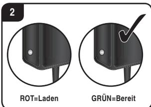
**Laden Sie den Akku unbedingt nach Gebrauch wieder auf um eine sog. Tiefentladung des Akkus zu vermeiden. Laden Sie den Akku von Zeit zu Zeit (ca. alle 2-3 Monate) auf. Eine Nichtbeachtung der o.g. Handhabung des Akkus kann zu einem Defekt führen. Das Aufladen des Akkus hat unter Aufsicht eines Erwachsenen zu erfolgen! Akkus dürfen nur von Erwachsenen oder von Kindern die mindestens 8 Jahre alt sind aufgeladen werden.**
