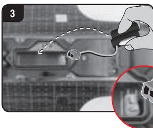
Verbinden Sie das Kabelende des Carrera RC-Boots mit dem des Akkus. Akku einlegen. Deckel mit einem Schraubenzieher zuschrauben.
