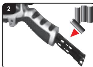
Przy wkładaniu baterii należy zwrócić uwagę na biegunowość baterii. Schowek na baterie ponownie wsunąć do kontrolera do momentu zaskoczenia zapadki. Nigdy nie używajcie Państwo jednocześnie nowych i starych baterii lub baterii pochodzących od różnych producentów. Gdy dioda kontrolna LED szybko miga, należy wymienić baterie w kontrolerze.
