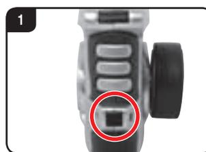
Pressione o botão "release" e retire o compartimento das pilhas para fora do comando.
