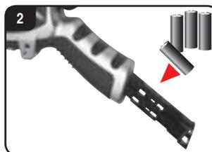
2 Vær ved ilægning af batterierne opmærksom på den rigtige polaritet. Skub batterienheden tilbage i controlleren til den går i indgreb. Brug aldrig nye og gamle batterier eller batterier fra forskellige producenter sammen. Når kontrol-LED'en blinker hurtigt, skal batterierne i controlleren udskiftes.
