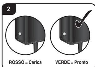
**Per evitare una cosiddetta scarica completa dell'accumulatore, ricaricarlo assolutamente dopo l'uso. Ricaricare l'accumulatore di tanto in tanto (ca. ogni 2 - 3 mesi). L'inosservanza del suddetto handling dell'accumulatore può causare difetti. La carica dell'accumulatore deve essere effettuata sotto la sorveglianza di un adulto! Gli accumulatori devono essere caricati solo da adulti o da bambini di almeno 8 anni.**
