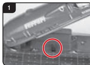
Le bateau doit être, le cas échéant, relié avec le contrôleur lors de la première utilisation. Cela signifie que vous devez d'abord activer le contrôleur puis brancher l'accumulateur sur le bateau, démarrer ensuite le bateau et finalement appuyer sur le petit bouton se trouvant dans le compartiment à piles jusqu'à ce que la lampe LED s'allume en permanence. (voir également : remplacement de la pile)
