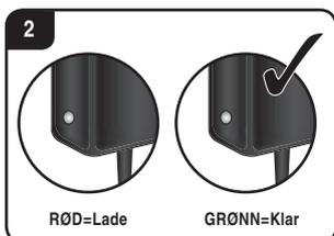
**Etter bruk må akkumulatoren lades, slik at en total utladning forhindres. Akkumulatoren må lades opp med jevne mellomrom (ca. hver 2-3 måned). Hvis denne håndteringen av akkumulatoren ignoreres, kan det oppstå en defekt. Batteriet må lades under oppsikt av en voksen person! Batterier skal kun lades av voksne personer, eller av barn som er minst 8 år gamle.**
