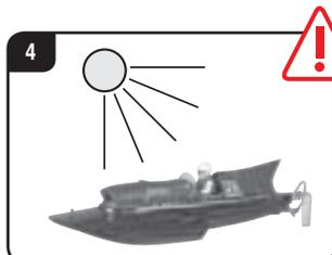
4 Ikke utsett Carrera RC-båten for direkte sol. For å unngå overoppheting i elektroniken til båten må man legge inn regelmessige hvilepauser ved en temperatur på over 35°C.
