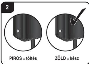
Kérjük, először csatlakoztassa a Carrera RC akkut a mellékelt töltőre. A csatlakozóelem, illetve az akku és a töltő közötti csatlakozás úgy van kialakítva, hogy a polaritások felcserélése ne legyen lehetséges. Csatlakoztassa a töltőt egy energiaforrásra.
