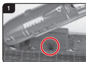
Na primeira colocação em funcionamento, o barco tem que ser interligado eventualmente com o comando. Ou seja: ligue primeiro o comando, coloque a pilha no barco, ligue-o e pressione o pequeno botão que se encontra no compartimento da pilha até a lâmpada LED ficar permanentemente acesa. (Ver também "modo de colocar a pilha")
