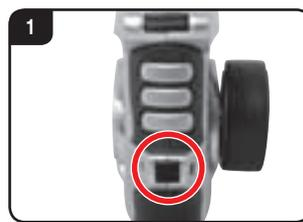
Pritisnite na gumb za sprostitev in vzemite predalček za baterije iz upravljalnika.
