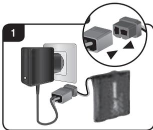
Reliez dans un premier temps la batterie Carrera RC au chargeur fourni. La prise de raccordement entre la batterie et le chargeur a été conçue de sorte à éviter toute inversion de polarité. Raccordez ensuite le chargeur à une prise de courant.
