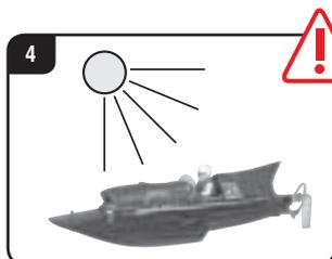
Non esporre la barca Carrera RC a irradiazioni solari dirette. Per evitare surriscaldamenti dell'elettronica della barca, a temperature superiori a 35°C si devono effettuare pause regolari.
