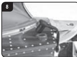
Gelieve na iedere vaart de ledigingsstop aan de achtersteven te openen en hierlangs het eventueel ontstane condenswater te verwijderen. Steek de ledigingsstop eerst weer onmiddellijk voor gebruik van de boot weer in de voorziene opening.
