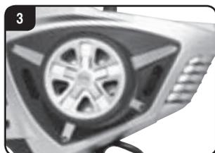
A 2,4 GHz vezérlőt jobb- és balkezesek is használhatják, csak a kormányegységet kell más helyre csavarozni.
