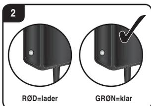
**Oplad ubetinget akku'en efter brug for at undgå en såkaldt dybdeafledning af denne. Oplad akku'en regelmæssigt (ca. hver 2-3 måneder). Ignorering af ovennævnte håndteringsmåde kan medføre en defekt. Akku'en må kun oplades under opsyn af en voksen! Akku'er må kun oplades af voksne eller af børn på mindst 8 år.**
