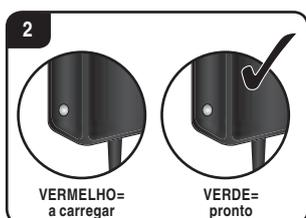
**Carregue a pilha necessariamente depois de cada uso para evitar a denominada descarga total da mesma. Carregue a pilha de quando em quando (aprox. cada 2-3 meses). A inobservância do manejo anteriormente descrito, pode provocar defeitos. O carregamento da pilha tem de ser efetuado sob a vigilância de um adulto! As pilhas devem ser carregadas unicamente por adultos ou por crianças de pelo menos 8 anos de idade.**
