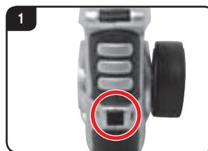
Appuyez sur le bouton «release» et retirez le compartiment à piles du contrôleur.
