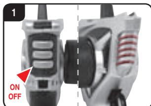
Lorsque le contrôleur est enclenché, les lampes LED rouges dans la zone avant du contrôleur s'allument.
