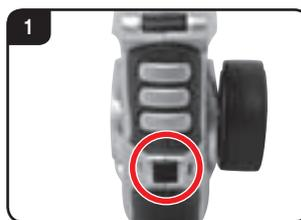
1 Tryk på release-knappen og tag batterienheden ud af controlleren.
