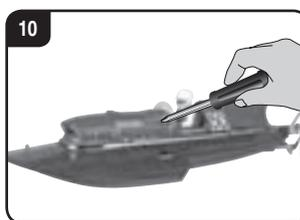
Die korrekte Montage des Carrera RC-Boots muss stets vor und nach jeder Fahrt überprüft werden, gegebenenfalls Schrauben und Muttern nachziehen.
