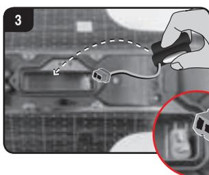
Branchez le câble du bateau à la batterie. Insérez la batterie dans son compartiment avant de remettre le couvercle et de la visser à l'aide d'un tournevis.
