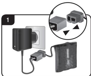
Koppla först ihop Carrera RC-ackumulatorn med bipackade laddare. Förbindelsedelen resp. anslutningen mellan ackumulator och laddare är konstruerade så att det inte går att kasta om polariteten. Anslut laddaren till en energikälla.
