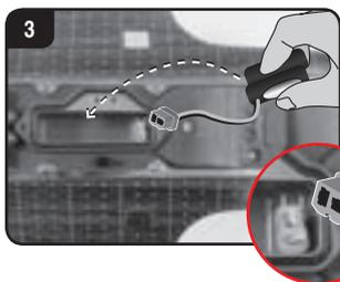
Połączyć koniec przewodu łodzi Carrera RC z przewodem akumulatora. Włożyć akumulator górną część łodzi z pomocą wkrętaka.
