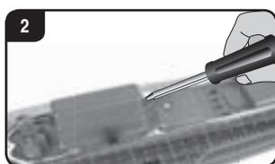
Con un cacciavite togliere il coperchio del vano della batteria della barca Carrera RC.
