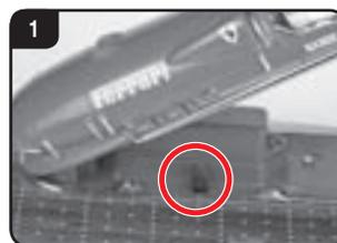
Při prvním spuštění musí být člun příp. propojen s ovladačem. To znamená: Zapněte nejdříve ovladač, nastrčte akumulátor do člunu, zapněte člun a stiskněte malé tlačítko, které se nachází v příhrádce na baterie, dokud se LED kontrolka trvale nerozsvítí. (Viz také Vložení akumulátorové baterie)
