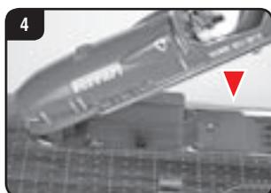
Vuelva a colocar la parte superior de la lancha (junto a la figura y la cabina) cuidadosamente sobre el fuselaje, procurando que el conmutador de corredera vuelva a engatillarse correctamente.
