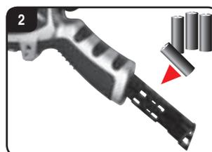
Veillez respecter la bonne polarité lors de l'insertion des piles. N'utilisez jamais de piles de différents fabricants ou de piles usagées et neuves ensemble. Remplacez le compartiment à piles dans le contrôleur jusqu'à ce qu'il s'enclenche. Quand la DEL de contrôle clignote rapidement, les batteries doivent être remplacées dans le contrôleur.
