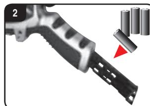
Při vkládání baterií dejte pozor na správnou polaritu. Nasuňte příhrádku s bateriemi zpět do ovladače tak, aby zaskočila. Nikdy nepoužívejte společně nové a staré baterie nebo baterie od různých výrobců. Jestliže LED kontrolka bliká rychle, je nutné vyměnit baterie v ovladači.
