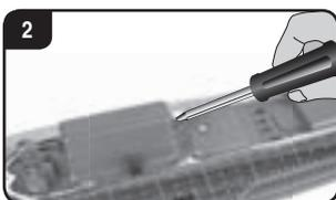
Entfernen Sie mit einem Schraubenzieher den Deckel des Akkufachs beim Carrera RC-Boot.
