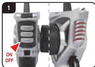
1 Cuando el controlador está conectado, se le iluminan las lámparas LED rojas de la parte delantera.
