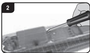
Z izvijačem odstranite pokrovček predalčka za akumulator na čolnu Carrera RC.
