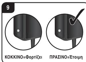
Προς αποφυγή πρόκλησης βλαβών στο σύστημα ελέγχου του σκάφους Carrera RC και κατ' επέκταση προς αποφυγή ανεξέλεγκτης κίνησής του, πρέπει να ελέγχετε από πριν, αν οι μπαταρίες του χειριστηρίου και οι επαναφορτιζόμενες μπαταρίες του σκάφους, είναι καλά φορτισμένες. Μην βραχυκυκλώνετε φορτιστές και τροφοδοτικά.
