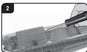
Servez-vous d'un tournevis pour retirer le couvercle du compartiment de la batterie du bateau Carrera RC.
