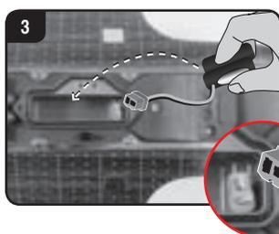
3 Verbind het kabeluiteinde van de Carrera RC-boot met dat van de accu. Accu inleggen. Deksel met een schroevendraaier dichtschroeven.
