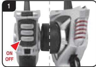
Kun ohjain on kytketty päälle, ohjaimen etuosassa olevat punaiset LED-lamput palavat.
