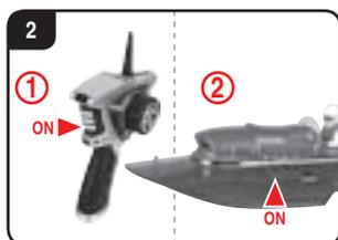
**Při spuštění vždy nejdříve zapněte ovladač a potom člun. Pro vypnutí po jízdě dodržujte obrácené pořadí!**
