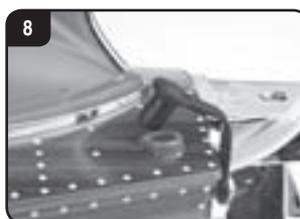
Po každé jízdě otevřete vypouštěcí zátku na zádi člunu a vypusťte kondenzovanou vodu, která se zde případně mezitím nashromáždila. Vypouštěcí zátku znovu zastrčte do určeného otvoru až bezprostředně před dalším použitím člunu.
