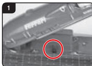
Ved første bruk må båten ev. forbindes med kontrolleren. Det vil si: Slå først på kontrolleren, sett akkumulatoren i båten, slå båten på og trykk på den lille knappen som finnes i batterirommet, helt til LED-lampen lyser konstant. (Se også Sette inn akkumulator)
