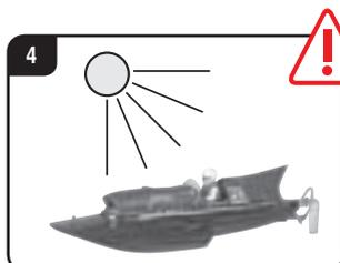
N'exposez pas le bateau Carrera RC directement aux rayons du soleil. Pour éviter la surchauffe de l'électronique dans le bateau, il faut intercaler régulièrement de courtes pauses lorsque la température extérieure est supérieure à 35 °C.
