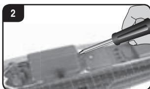
Fjern dekelet til akkumulatorrommet i Carrera RC-båten med en skrutrekker.
