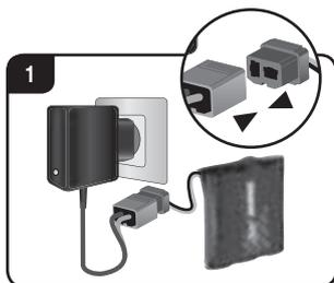
En primer lugar, conecte la batería Carrera RC al cargador adjunto. La pieza de unión o la conexión entre la batería y el cargador están fabricadas de modo que quede excluida la polaridad inversa. Conecte el cargador a una fuente de corriente.
