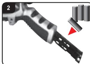
Se til at batteriene har riktig polaritet når de legges inn. Skyv batterirommet inn i kontrolleren igjen, til det låses fast. Du må aldri bruke nye og gamle batterier samtidig, eller batterier fra ulike produsenter. Når kontroll-LED blinker raskt, må batteriene i kontrolleren skiftes ut.
