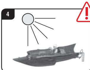
Carrera RC -venettä ei saa altistaa suoralle auringonpaisteelle. Veneen elektronikan ylikuumenemisen estämiseksi on yli 35 °C lämpötiloissa pidettävä säännöllisesti lyhyitä taukoja.
