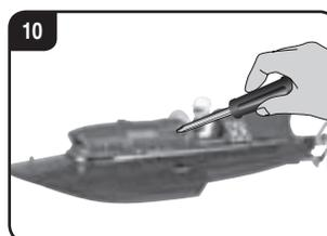
Contrôlez le montage correct du bateau Carrera RC avant et après chaque course et resserrez les vis et écrous si besoin est.
