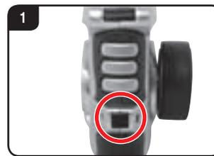
Drücken Sie auf den Releaseknopf und nehmen Sie das Batteriefach aus dem Controller.
