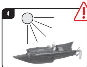
Nevystavujte člun Carrera RC přímému slunečnímu záření. Aby nedocházelo k nadměrnému přehřívání elektroniky v člunu, je nutné při teplotě nad 35°C vkládat pravidelně krátké přestávky.
