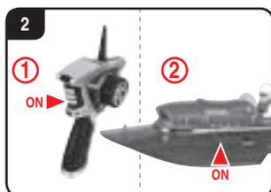
**Bei Inbetriebnahme immer zuerst den Controller und dann das Boot einschalten.**
