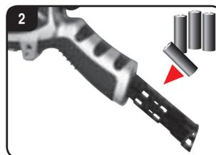
Pri vstavljanju baterij pazite na pravilno polarnost. Predalček za baterije potisnite nazaj v upravljalnik, dokler ne zaskoči. Nikoli hkrati ne uporabljajte novih in starih baterij ali od različnih proizvajalcev. Če kontrolna LED dioda hitro utripa, je treba zamenjati baterije v upravljalniku.
