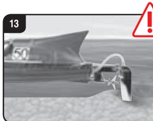
**Evitar necessariamente o contacto da hélice e do leme com o fundo.** A inobservância desta indicação, pode provocar danos duradouros ou afectar gravemente a governação e/ou a velocidade do barco. Se for necessário, substitua a hélice pela hélice de substituição.
