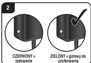
Po użytkowaniu prosimy bezwarunkowo ponownie naładować akumulator w celu uniknięcia tzw. głębokiego rozładowania akumulatora. Prosimy o ładowanie akumulatora co pewien czas (raz na około 2-3 miesiące). Nieprzestrzeganie powyżej podanych zasad obsługi może doprowadzić do uszkodzenia akumulatora. Ładowanie akumulatorów może następować wyłącznie pod nadzorem osoby dorosłej! Ładowania akumulatorów mogą dokonywać wyłącznie osoby dorosłe lub dzieci w wieku co najmniej 8 lat.
