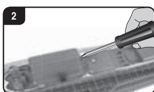
Retire a tampa do compartimento da bateria do barco Carrera RC com uma chave de fendas.
