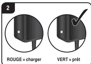
**Rechargez votre accu après utilisation afin d'éviter une décharge profonde de celui-ci. Chargez votre accu de temps en temps (environ tous les 2 à 3 mois). La non-observation de l'utilisation mentionnée précédemment peut provoquer une détérioration de l'accu. Le chargement de la batterie doit être effectué sous la surveillance d'un adulte ! Les piles doivent être chargées uniquement par des adultes ou des enfants de 8 ans ou plus.**
