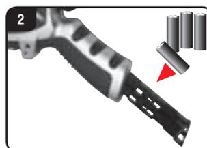
Se till att batterierna hamnar rätt med avseende på polariteten. Skjut tillbaka batterifacket i kontrollen tills att det hakar i. Använd aldrig nya och gamla batterier ihop, eller batterier från olika tillverkare. Om kontrollampen blinkar snabbt måste batterierna i kontrollen bytas.
