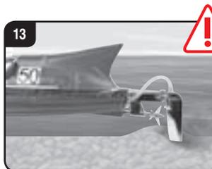
**Bezpodmínečně zabraňte tomu, aby se hnací šroub resp. kormidlo dostalo do kontaktu se zemí.** Nedodržení tohoto pokynu může způsobit trvalé poškození a velmi nepříznivě ovlivnit schopnost manévrování resp. rychlost člunu. V případě potřeby vyměňte hnací šroub za náhradní šroub.
