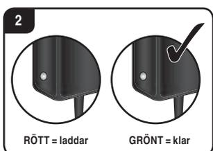
**Ladda ovillkorligen alltid upp batteriet igen efter användningen för att undvika en s.k. djupurladdning av det. Ladda upp batteriet då och då (ca varannan till var tredje månad). En ignorering av ovannämnda handhavande kan leda till att batteriet försätors. Batteriet skall laddas under överinseende av en vuxen! Batterier får laddas endast av vuxna, eller av barn som är minst 8 år gamla.**
