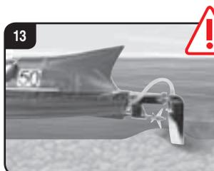
**Feltétlenül kerülni kell, hogy a propeller ill. a kormány érintkezzenek a talajjal.** Ennek figyelmen kívül hagyása tartós károkat okozhat és nagymértékben negatívan befolyásolhatja a hajó manőverezési képességét ill. sebességét. Szükség esetén a propellert cserélje ki a tartalék propellerre.
