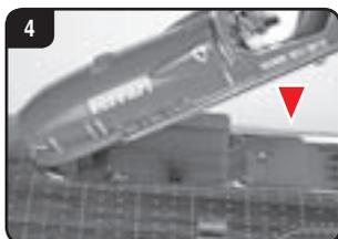
4 Sæt igen den øverste del af båden (med figur og cockpit) forsigtigt på skroget. Vær derved opmærksom på, at skydekontakten igen går korrekt i indgreb.
