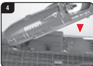
Setzen Sie das obere Teil des Bootes (mit Figur & Cockpit) vorsichtig wieder auf den Rumpf auf. Achten Sie dabei darauf, dass der Schiebeschalter wieder ordnungsgemäß einrastet.
