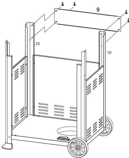
Den Querträger hinten (9) mit Schrauben M6 x 10 (A) an den hinteren Standbeinen (10,25) befestigen.
