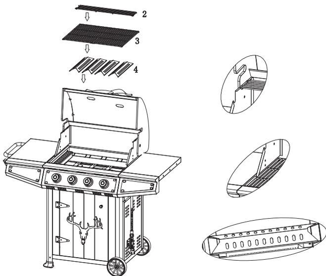
Die vier Flammverteilerplatten (4), die Grillroste (3) und das Warmhaltegitter (2) in dem Brennergehäuse platzieren.
