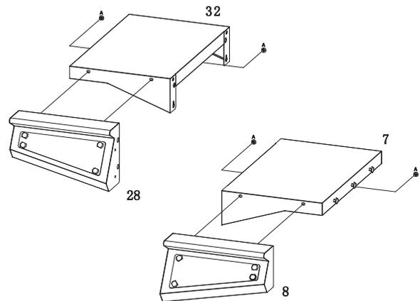
Die Blende für linke Seitenablage (28) mit Schrauben M6 x 10 (A) an der linken Seitenablage (32) befestigen.
