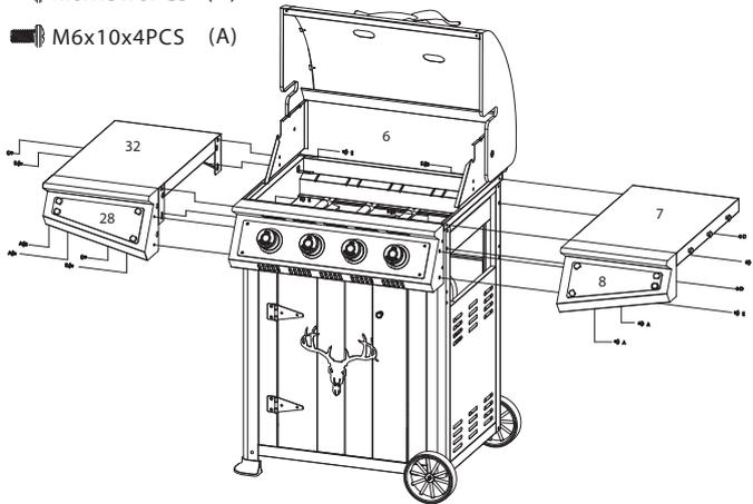
Die rechte und die linke Seitenablage (7,28) mit Schrauben M6 x 10 (A), M6 x 15 (E) und Muttern M6 (D) rechts und links am Brennergehäuse (6) und der Bedienblende befestigen.
