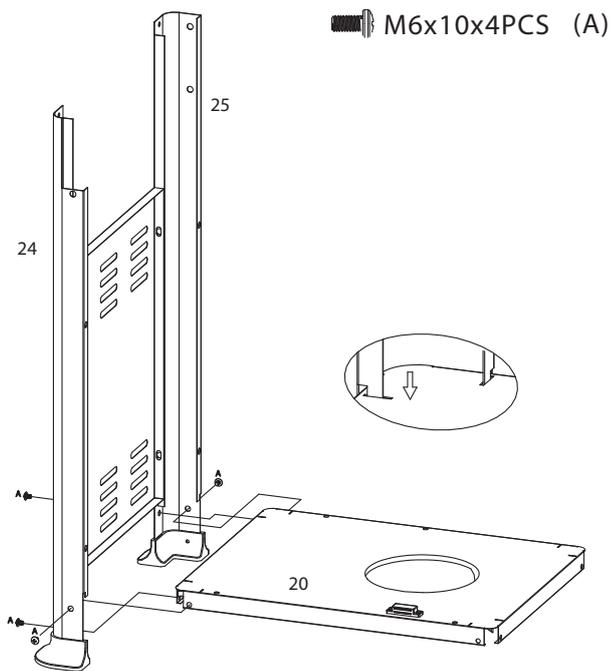
Die Bodenplatte (20) ausrichten und mit Schrauben M6 x 10 (A) an die linken Standbeine (24,25) schrauben.
