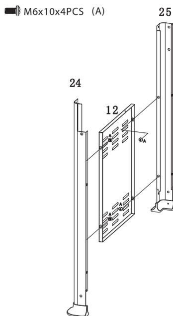
Linke Seitenabdeckung (12) und Standbeine vorne links (24) und hinten links (25) mit Schrauben M6 x 10 (A) verbinden.
