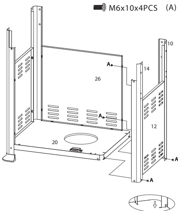
Die rechte Seitenabdeckung (12) mit dem Standbeinen rechts (14,10) ausrichten und mit Schrauben M6 x 10 (A) an der Bodenplatte (20) und der Rückwand (26) befestigen.
