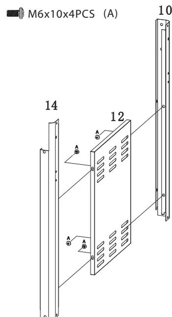
Rechte Seitenabdeckung (12) und Standbeine vorne rechts (14) und hinten rechts (10) mit Schrauben M6 x 10 (A) verbinden.
