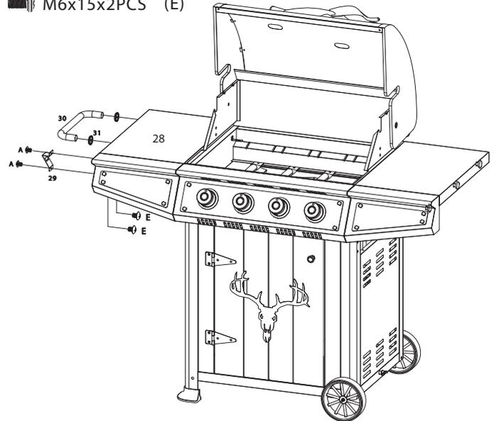
Den Seitengriff (30) mit Schrauben M6 x 15 (E) und Unterlegscheiben (31) an der linken Seitenablage (28) befestigen.
