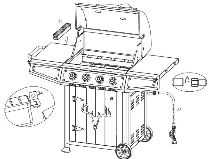
Falls nicht vormontiert, die beiden Halter für Aromabox (34) links im Brennergehäuse befestigen.
