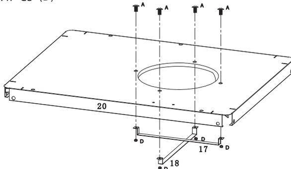
Die Gasflaschenträger (17,18) über Kreuz (17 auf 18) mit Schrauben M6 x 10 (A) und M6 Muttern (D) unter die Bodenplatte (20) schrauben.
