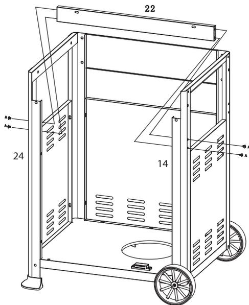
Den Türquerträger (22) mit Schrauben M6 x 10 (A) an den vorderen Standbeinen (14,24) befestigen.
