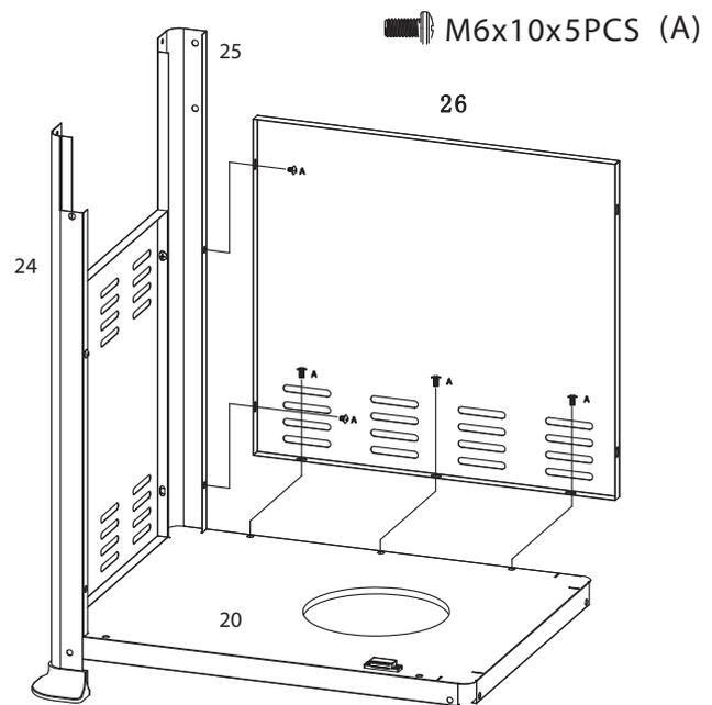
Die Rückwand (26) mit Schrauben M6 x 10 (A) an die linken Standbeine (24,25) und die Bodenplatte (20) schrauben.
