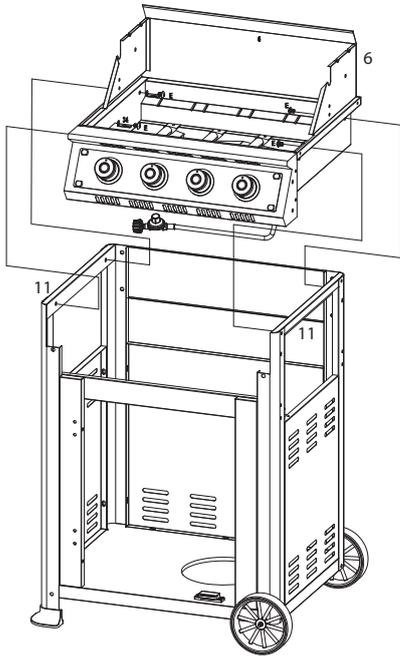
Das Brennergehäuse (6) mit Schrauben M6 x 15 (E) an den Querträgern rechts/links (11) befestigen.
