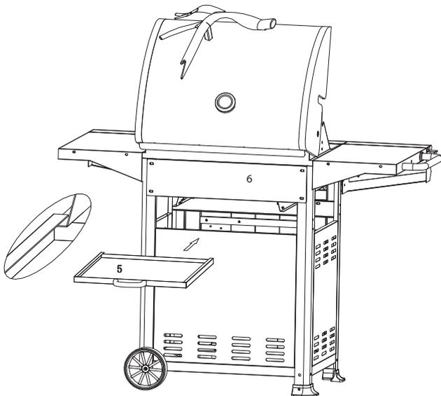
Das Fettauffangblech (5) von hinten auf der Führungsschiene unter das Brennergehäuse (6) schieben.
