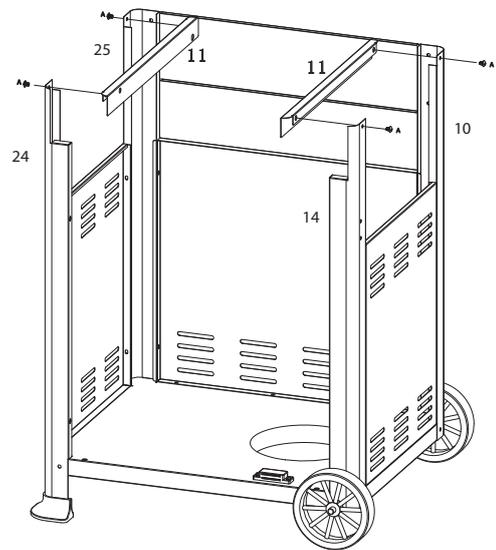
Die Querträger rechts/links (11) mit Schrauben M6 x 10 (A) an den linken (24,25) und den rechten (10,14) Standbeinen befestigen.
