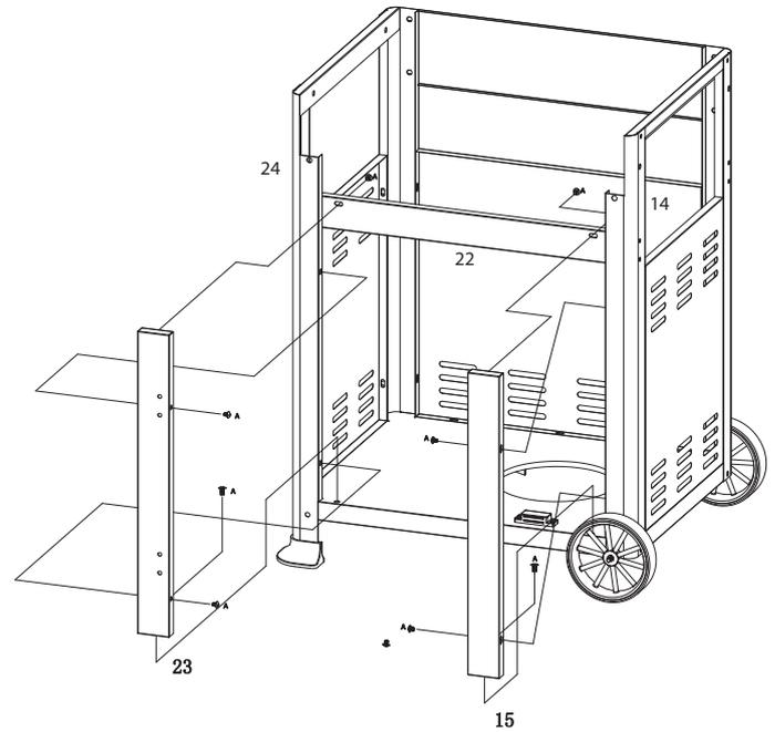
Die Türblenden rechts und links (15,23) mit Schrauben M6 x 10 (A) an den vorderen Standbeinen (14,24), der Bodenplatte (20) und dem Türquerträger (22) befestigen.
