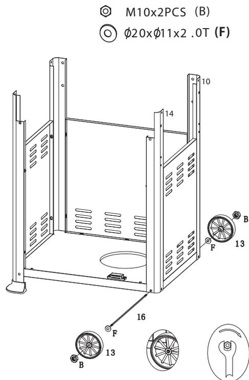
Die Radachse (16) durch die Löcher am Ende der rechten Standbeine (14,10) schieben und an beiden Seiten mit Unterlegscheiben (F) bestücken.
