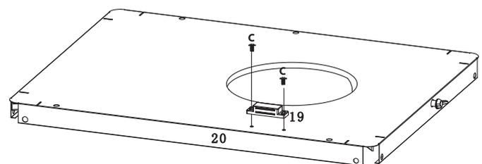
Den Türmagnet (19) mit M4 x 20 Schrauben (C) an die Bodenplatte (20) schrauben.
