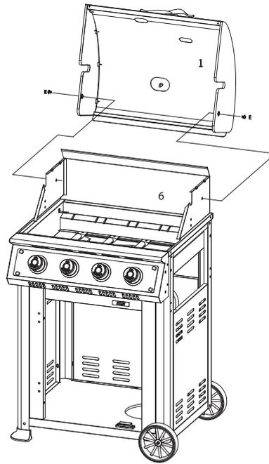
Den Deckel (1) mit Schrauben M6 x 15 (E) am Brennergehäuse (6) befestigen.
