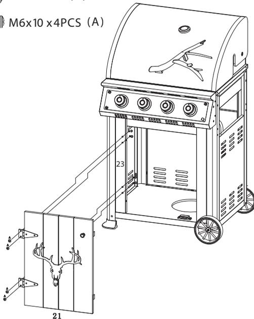
Die Scharniere der Tür (21) mit Schrauben M6 x 10 (A) und Muttern M6 (D) an der linken Türblende (23) befestigen.
