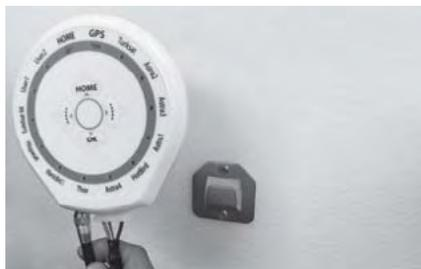
Befestigen Sie das Bedienpult mit der Halterung wo immer Sie möchten.
