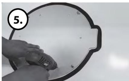
5. Legen Sie die Platte auf und bohren Sie die 6 Löcher mit einem 2 mm Bohrer.
