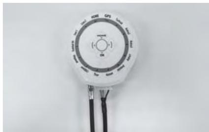
Verbinden Sie das Steuerkabel und die Stromversorgung mit dem Bedienpult.
