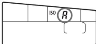
Wenn die ISO-Empfindlichkeit auf „A“ eingestellt ist, wird die tatsächliche ISO-Empfindlichkeit angezeigt, wenn Sie den Auslöser halb durchdrücken. Wie unten gezeigt, wird die ISO-Empfindlichkeit je nach Aufnahmemodus automatisch angepasst.
