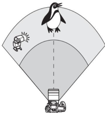
Hier sehen Sie die grundlegende Anordnung für eine vollautomatische Aufnahme mit Blitz mit einem Speedlite. **Die Schritte 1 bis 3 und 6 bis 7 gelten für alle Aufnahmen mit drahtlosem Blitz. Sie sind daher in der Erklärung der anderen Blitzanordnungen auf den folgenden Seiten nicht enthalten.** Die Symbole <☑> und <📷> auf den Menübildschirmen beziehen sich auf das externe Speedlite, und die Symbole <📷> und <📷> beziehen sich auf das integrierte Blitzgerät.
