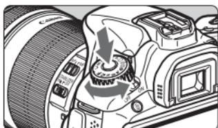
Halten Sie die Sperrtaste in der Mitte des Modus-Wählrads gedrückt, während Sie das Modus-Wählrad drehen.
