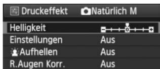
Wählen Sie in Schritt 4 auf Seite 240 den Druckeffekt aus. Drücken Sie die Taste <INFO.>, wenn das Symbol <☰> hell neben <INFO.> angezeigt wird. Sie können nun den Druckeffekt anpassen. Was angepasst oder angezeigt wird, hängt von der Auswahl ab, die Sie in Schritt 4 getroffen haben.
