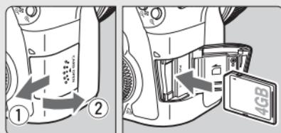
**Öffnen Sie die Abdeckung des Steckplatzes, und legen Sie eine Karte ein.** (S. 32)
