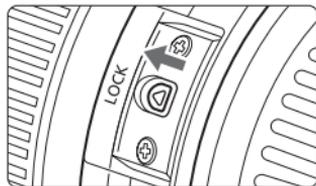
Sie können das Objektiv so einstellen, dass es beim Transport nicht ausfährt. Stellen Sie den Zoom-Ring auf 18 mm Weitwinkелеinstellung, und schieben Sie dann die Zoom-Ring-Verriegelung auf **<LOCK>**. Der Zoom-Ring kann nur bei Weitwinkелеinstellung verriegelt werden.
