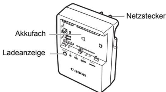
Dieses Ladegerät sollte ordnungsgemäß vertikal oder auf dem Boden aufgestellt sein.
