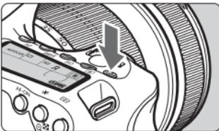
Sie können die Beleuchtung des LCD-Panels einschalten (☞6)/auschalten, indem Sie die Taste <☞6> drücken. Wenn Sie während einer Langzeitbelichtung den Auslöser ganz durchdrücken, wird die Beleuchtung des LCD-Panels ausgeschaltet.
