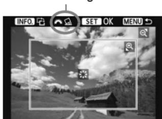
Sie können ein Bild zuschneiden und wie bei einer erneuten Auswahl des Bildausschnitts nur den gewünschten Bereich drucken. **Schneiden Sie das Bild direkt vor dem Drucken zu.** Wenn Sie die Zuschneideeinstellungen vor den Druckeinstellungen festlegen, müssen Sie unter Umständen die Zuschneideeinstellungen erneut vornehmen.
