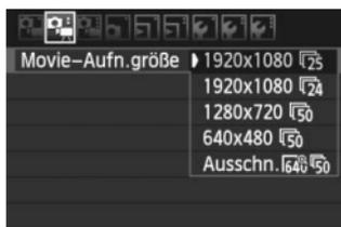
Auf der Registerkarte [📷] können Sie im Menü [Movie-Aufn.größe] die Movie-Aufnahmegröße [\*\*\*\*x\*\*\*\*] und die Bildrate [📺] (pro Sekunde aufgenommene Bilder) für das Movie auswählen. Die Einstellung [📺] (Bildrate) wird automatisch an die Einstellung [📺 Videosystem] angepasst.
