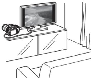
Schließen Sie die Kamera mit dem mitgelieferten AV-Kabel oder einem HDMI-Kabel HTC-100 (separat erhältlich) an ein Fernsehgerät an. So können Sie die aufgenommenen Movies und Bilder auf dem Fernsehgerät ansehen.
