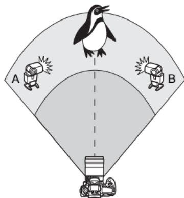
Teilen Sie die Slave-Einheiten in die Gruppen A und B ein, und ändern Sie das Blitzverhältnis je nach gewünschtem Belichtungsergebnis. Befolgen Sie die Anleitungen in der Bedienungsanleitung des Speedlite, um für die Slave-ID der einen Slave-Einheit A (Gruppe A) einzustellen, und für die Slave-ID der anderen Slave-Einheit B (Gruppe B) einzustellen. Positionieren Sie sie dann wie in der Abbildung gezeigt.
