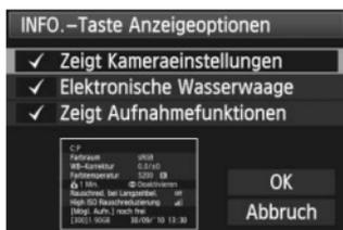
Wenn Sie die Taste **<INFO.>** drücken, während die Kamera aufnahmebereit ist, können Sie **[Zeigt Kameraeinstellungen]**, **[Zeigt Aufnahmeoptionen]** (S. 267) und **[Elektronische Wasserwaage]** (S. 127) anzeigen.
