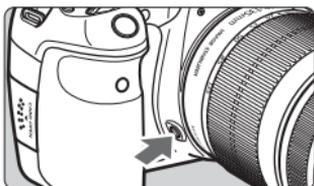
Drücken Sie die Schärfentiefenprüfungstaste, um mit der aktuellen Blendeneinstellung abzublenden. Sie können die Schärfentiefe (annehmbarer Fokusbereich) durch den Sucher überprüfen.
