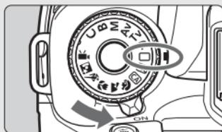
**Stellen Sie den Hauptschalter auf <ON>** (S. 28), halten Sie die Taste in der Mitte des Moduswährrads gedrückt, und stellen Sie das Wählrad auf <□> (Vollautomatik). (S. 54)
