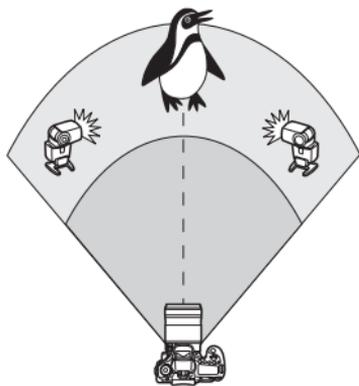
Diese Anordnung ist besonders hilfreich, wenn Sie eine hohe Blitzleistung benötigen. Alle Slave-Speedlites werden mit der gleichen Leistung ausgelöst und gesteuert, um eine Standardbelichtung zu erreichen.
