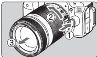
**Drücken Sie die Taste zur Objektiventriegelung, und drehen Sie gleichzeitig das Objektiv in die angegebene Pfeilrichtung.**
