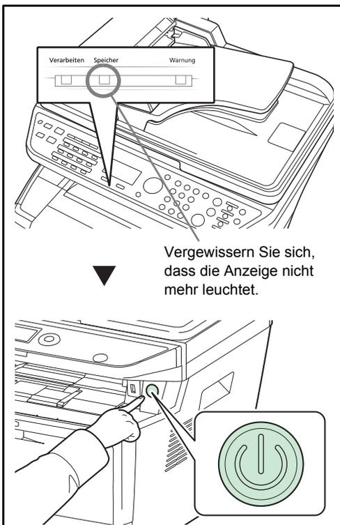
Achten Sie darauf, dass die Speicher-Anzeige erloschen ist, bevor Sie den **Netzschalter** betätigen.
