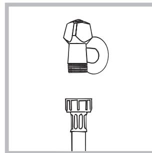
2. Conecte el tubo de alimentación enroscándolo a un grifo de agua fría con la boca rosada de 3/4 gas (ver la figura).
