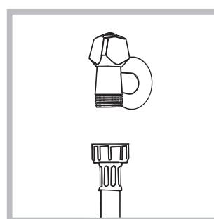
2. Realize a ligação do tubo de alimentação parafusando-o a uma torneira de água fria com bocal de rosca de 3/4 gás (ver figura).
