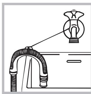
Em alternativa, coloque na beira de um lavabo ou de uma banheira, prendendo na torneira a guia fornecida com o produto (veja a figura). A ponta solta do tubo de descarga não deve permanecer emergida na água.
