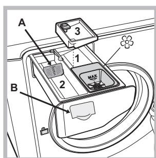
1. vaschetta per il prelavaggio: usare detersivo in polvere.
