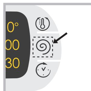
Para modificar las programaciones presionar levemente en el ícono dentro del área sensible (touch control) como se indica en la figura.
