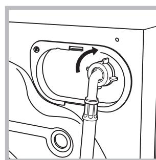
1. Ligue o tubo de alimentação na máquina de lavar roupa atarraxado no apropriado fornecimento da água, na parte traseira, em cima à direita (veja a figura).
