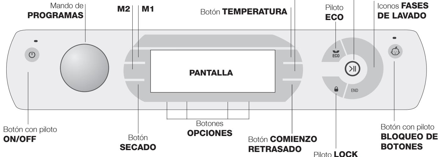
**Botón con piloto ON/OFF:** presione brevemente el botón para encender o apagar la máquina. El piloto verde indica que la máquina está encendida. Para apagar la lavasecadora durante el lavado, es necesario mantener presionado el botón durante más tiempo, aproximadamente 3 seg.; si se presiona en forma más breve o accidental, la máquina no se apagará. Si la máquina se apaga durante un lavado en curso, dicho lavado se anulará.
