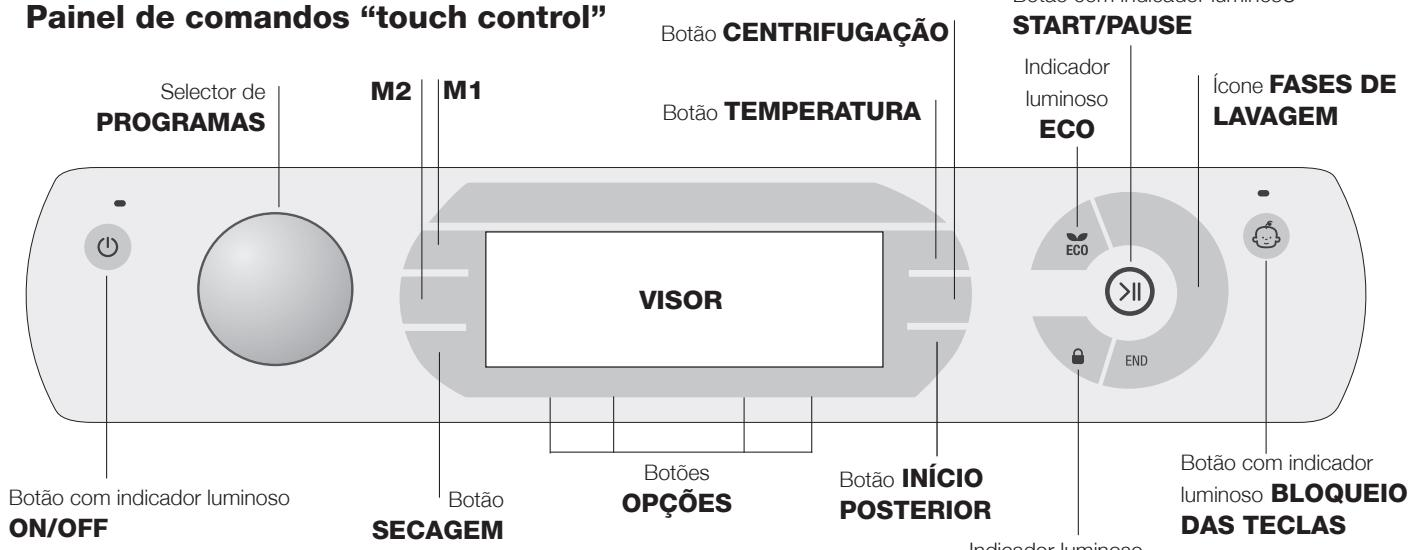
Botão com indicador luminoso **ON/OFF**: carregue brevemente no botão para ligar ou desligar a máquina. O indicador luminoso verde indica que a máquina está ligada. Para desligar a máquina de lavar roupa durante a lavagem, é necessário manter pressionado o botão por mais tempo, aproximadamente 3 segundos; uma pressão breve ou acidental não permitirá o desligamento da máquina. O desligamento da máquina durante uma lavagem em curso anula a própria lavagem.
