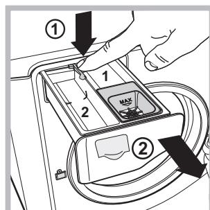
Para extraer el contenedor, presione la palanca (1) y tire hacia afuera (2) (*ver la figura*). Lávolo debajo del agua corriente, esta limpieza se debe realizar frecuentemente.
