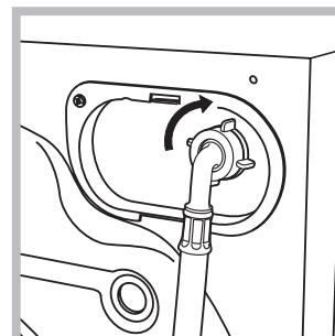
1. Conecte el tubo de alimentación a la máquina enroscándolo en la toma de agua correspondiente ubicada en la parte posterior derecha (arriba) (ver la figura).
