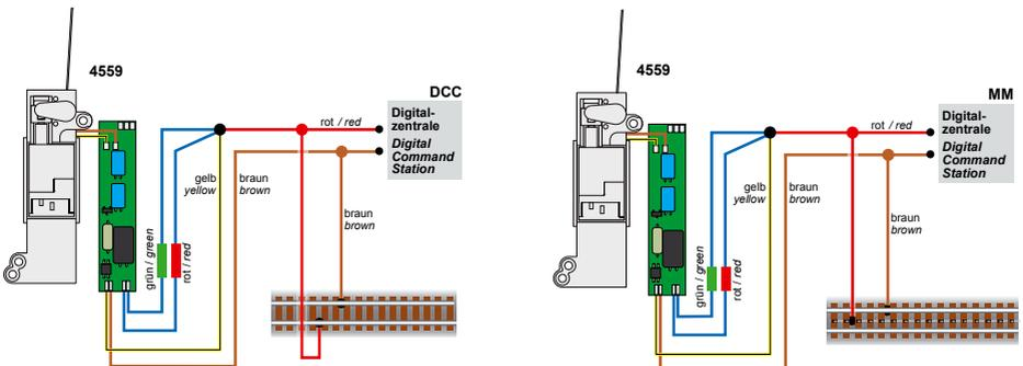
Anschluss nach Adressprogrammierung für invertierte Stellrichtung!
