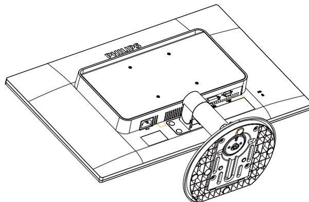
2. Entfernen Sie die vier Mylar-Streifen mit einem Schlitzschraubendreher von der Gelenkabdeckung.
