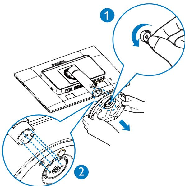
3. Entfernen Sie die Schrauben von der Gelenkabdeckung.
